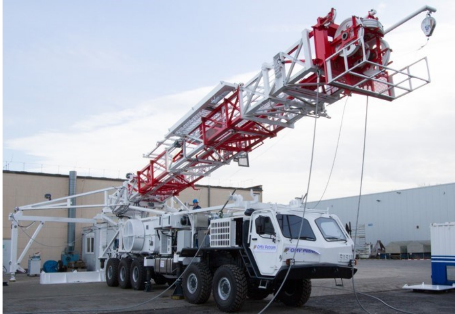
Figure 46: BIR type workover rig 183
