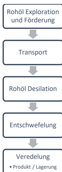
Abbildung 9: Prozessflussbild Dieselherstellung (eigene Darstellung nach (OMV, 2023))
