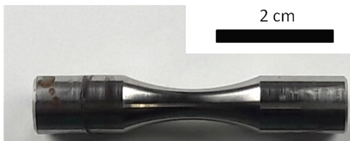
Abbildung 3.6: Biegeumlaufprobe (BUP) nach DIN 50113:1982-03.
