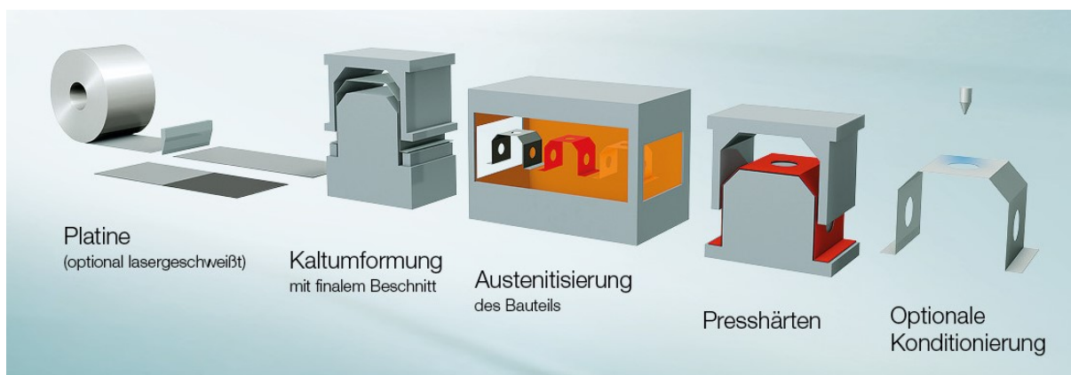
Abbildung 2-9: Schematische Darstellung des indirekten Prozesses zur Herstellung verzinkter presshärtender Bauteile [28].
