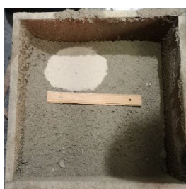
Abb. 4-30: Sandfläche nach Kaufmann auf der Prüffläche der SpC-Probe
