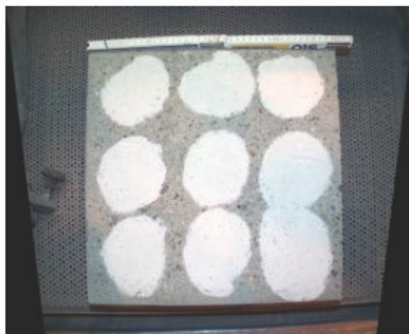
Abb. 4-17: Sandkreise auf einer Oberflächentextur zur Bestimmung deren Rautiefe (Mazin Kadhim El-Tornachi 2003)
