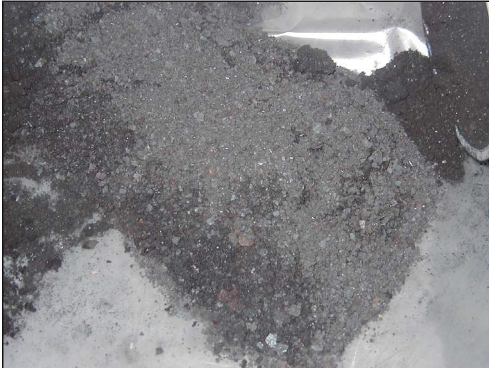
Abbildung 2.1: Photo einer Walzzunderprobe
