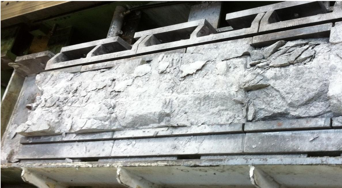
**Abbildung 17: Löseverhalten durch Disken<sup>37</sup>**
