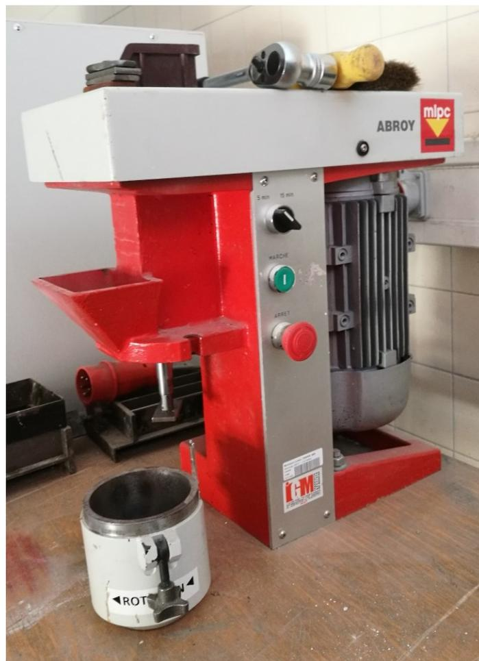
**Abbildung 22: LCPC Gerät mit Probenbehälter**
