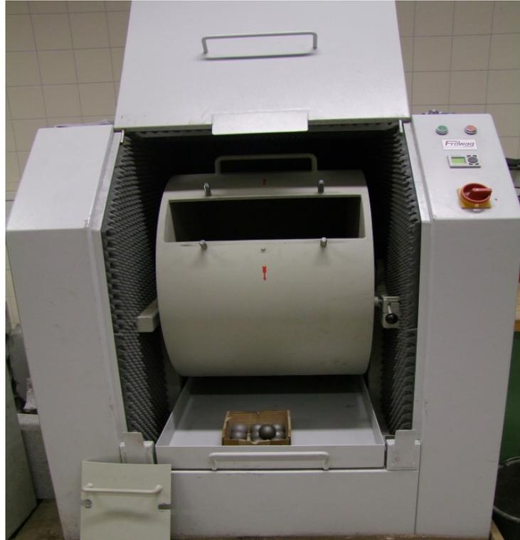
**Abbildung 25: LA Prüfeinrichtung<sup>47</sup>**
