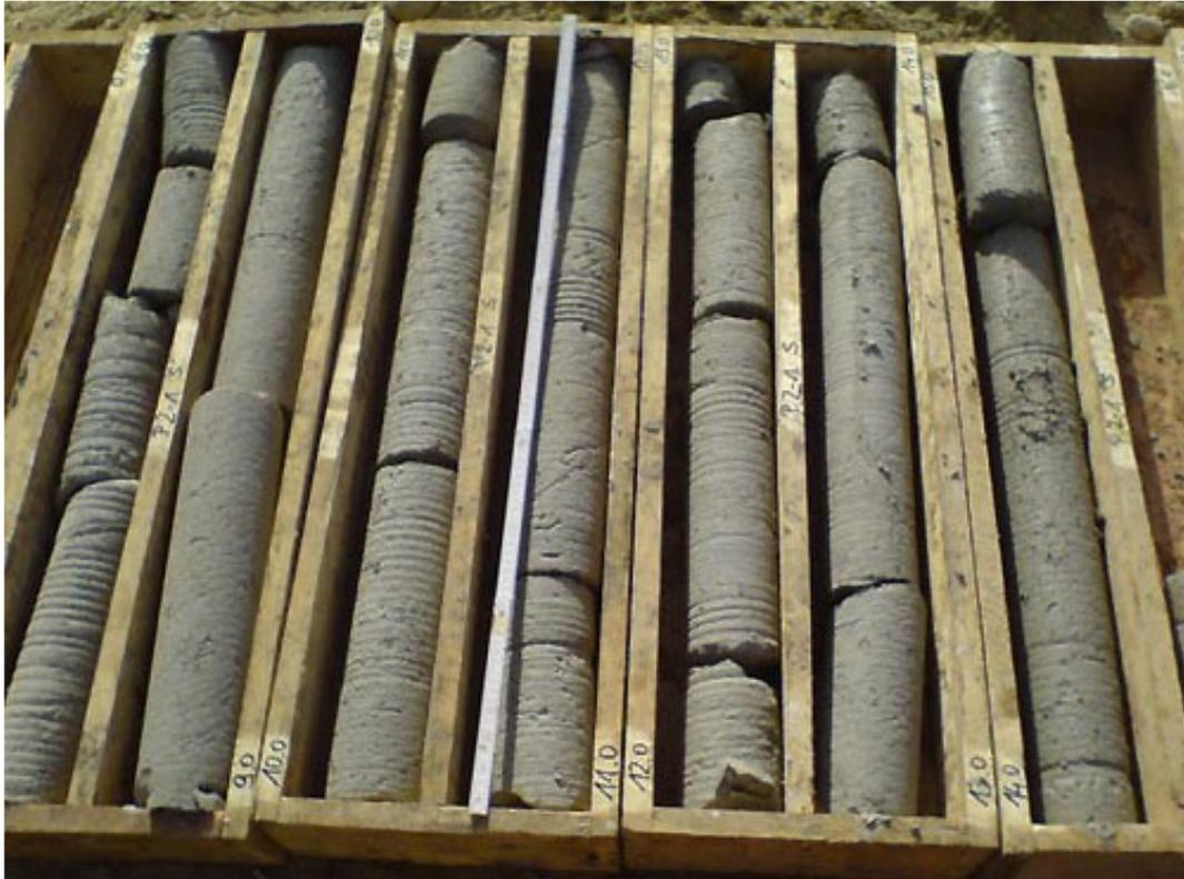
**Abbildung 2: gewonnene Bohrkerne<sup>6</sup>**
