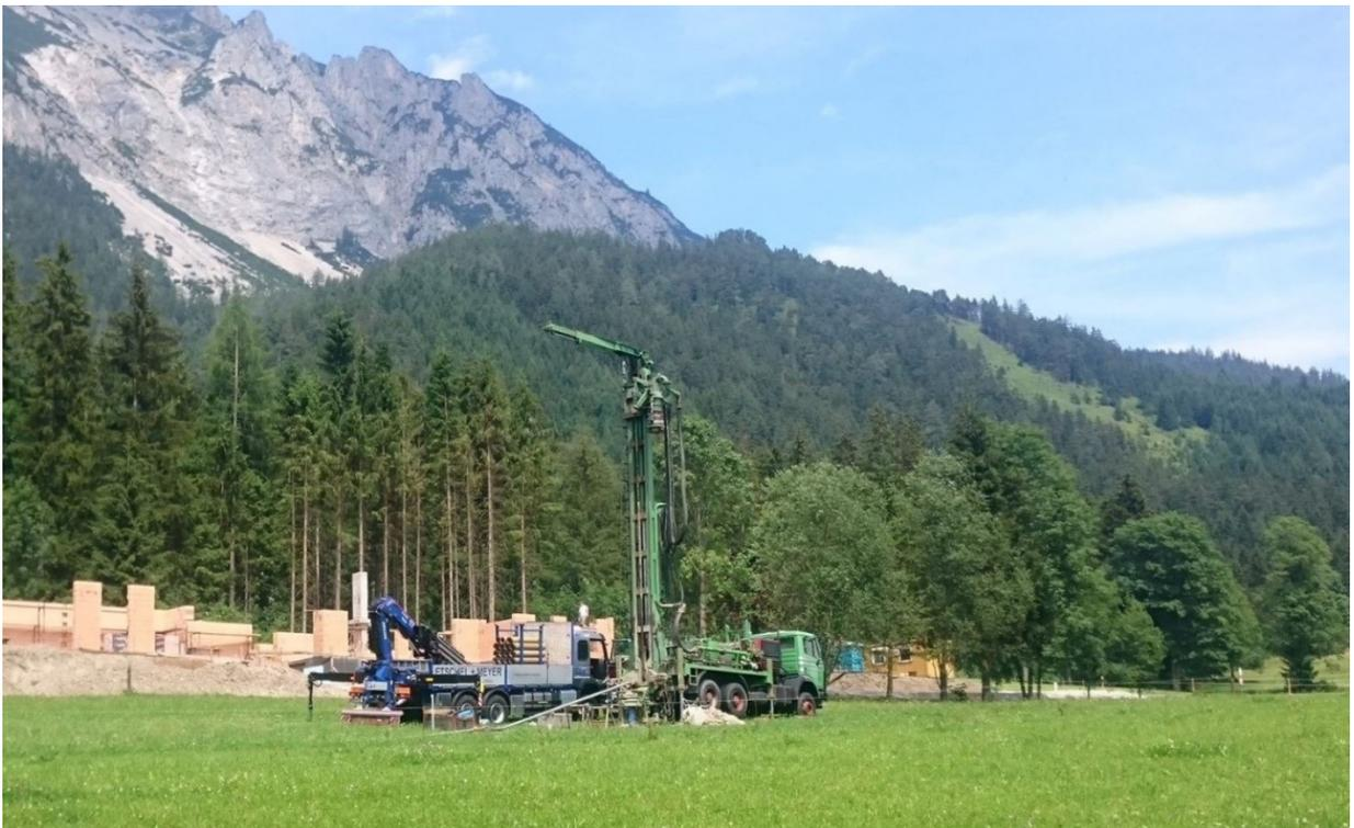
**Abbildung 1: Bohrgerät zur Gewinnung von Bohrkernen<sup>5</sup>**
