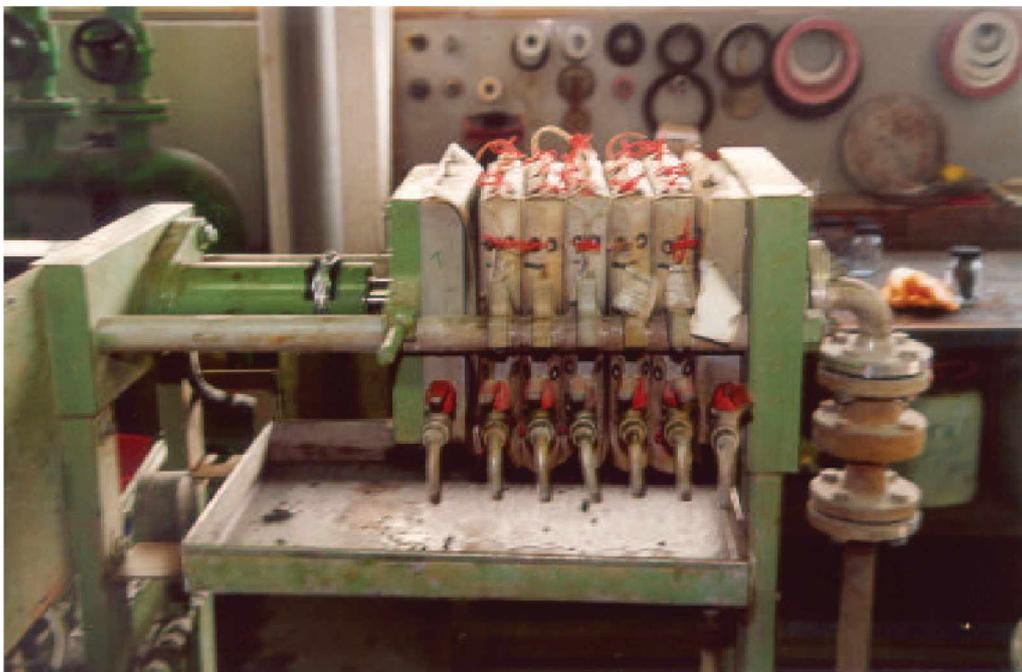
Abbildung 5: Laborkammerfilterpresse
