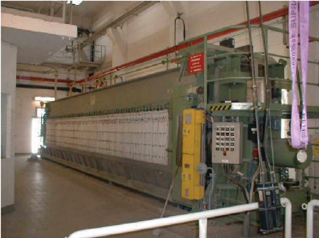
Abbildung 2: Kammerfilterpresse der CHEMARA
