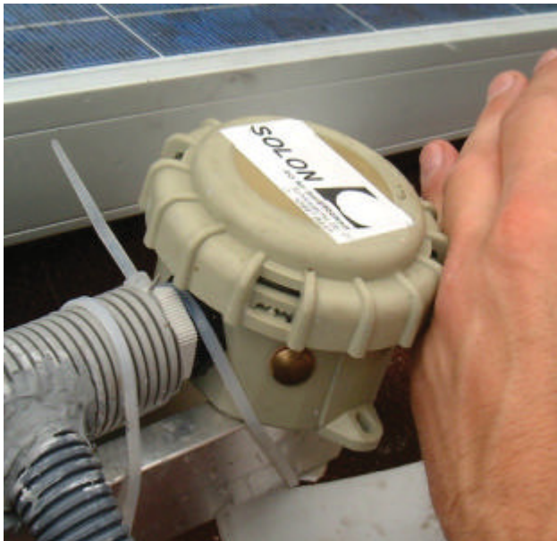
Bild 7-12 Umgebungstemperatursensor PT-100 -Detail
