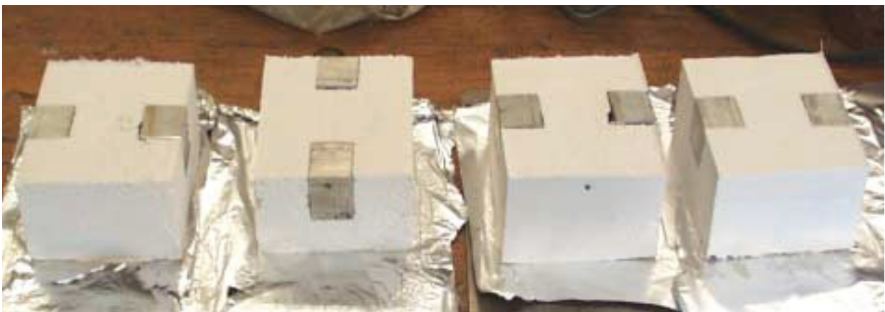
Abbildung 4.13: Vakuumformteile vor dem Trocknen
