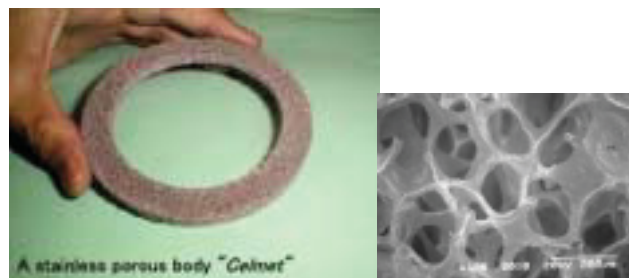
Abbildung 2.41: Bauteil und 150 fache Vergrößerung eines Ausschnittes dieses Bauteiles [56]
