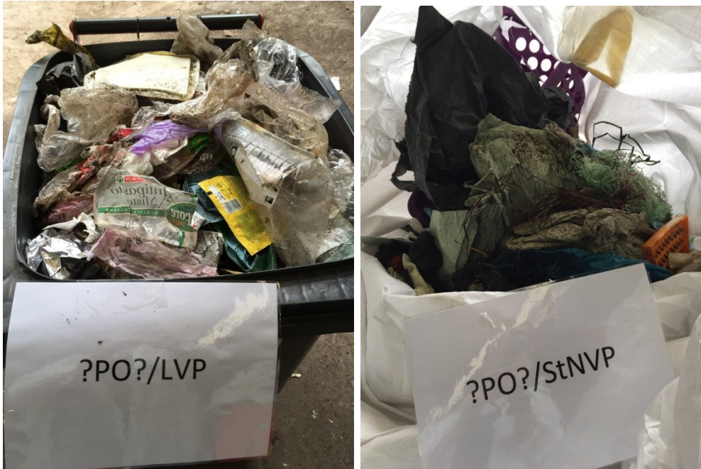
Abbildung 9: Zwei unbekannte Kunststofffraktionen, die im Labor mit einem Infrarotspektrometer untersucht wurden.
