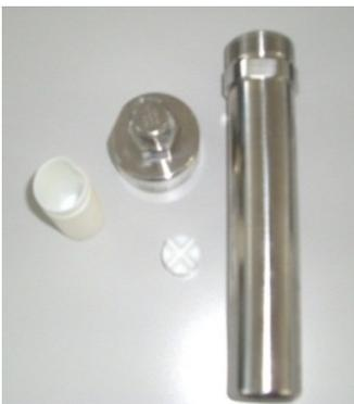
*Abb. 36: Druckbehälter zur Polymersynthese.*
