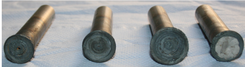
Abbildung 54: Vorderansicht der Proben nach dem Reibversuch auf der TORA. An der rechten äußeren Probe ist ein Bruch zu erkennen der durch das Trennen des verschweißten Werkzeugs entstanden ist.
