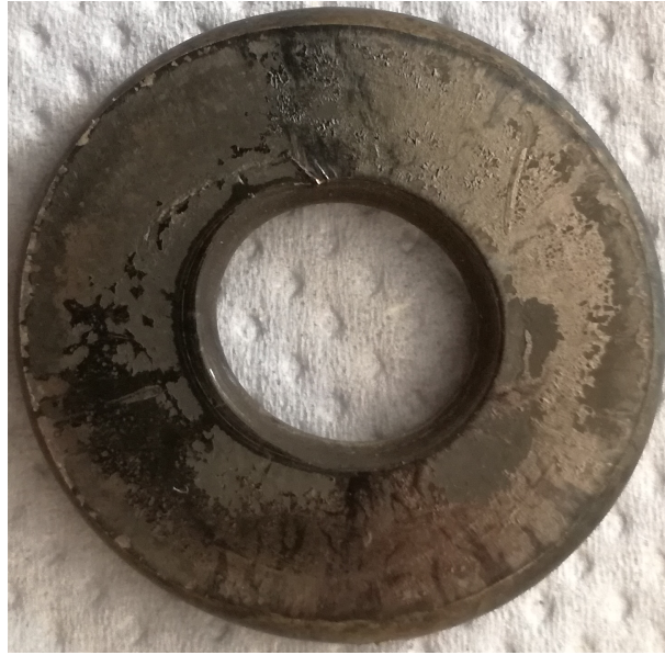
Abbildung 31: Ringstauchprobe mit stark verformten Innendurchmesser durch den Effekt der Gefügeinhomogenität.
