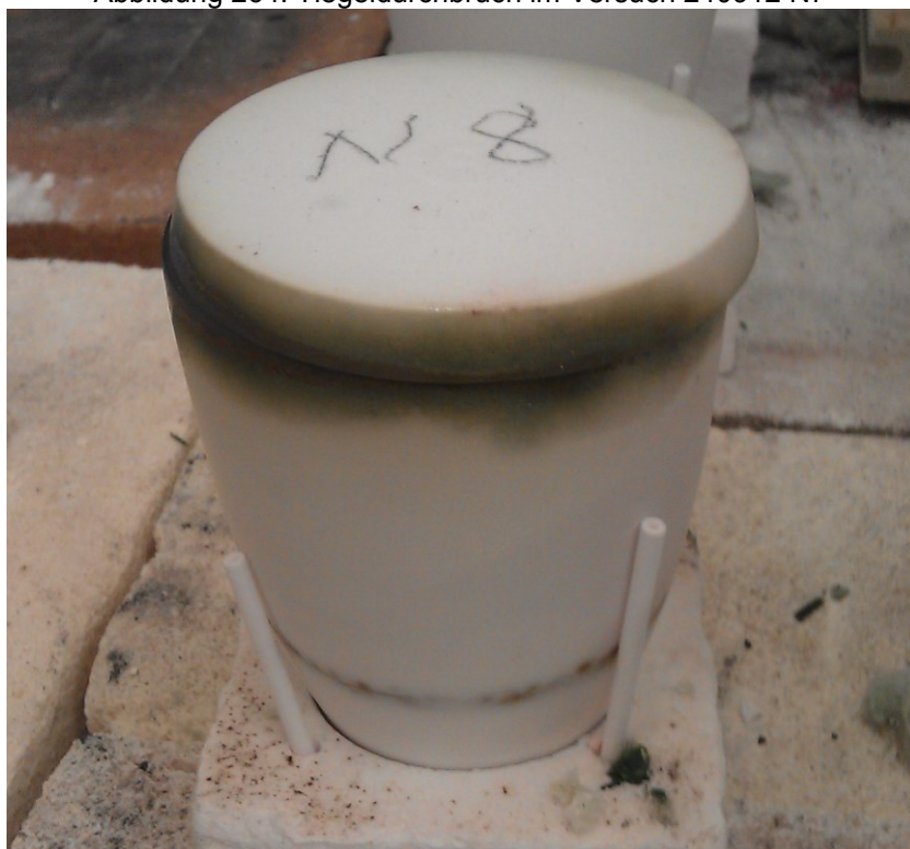
Abbildung 265: Starker Tiegelangriff im Versuch 240912 N8
