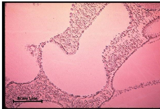
Abbildung 7: ETP-Kupfer mit 99,90 % Cu [13]
