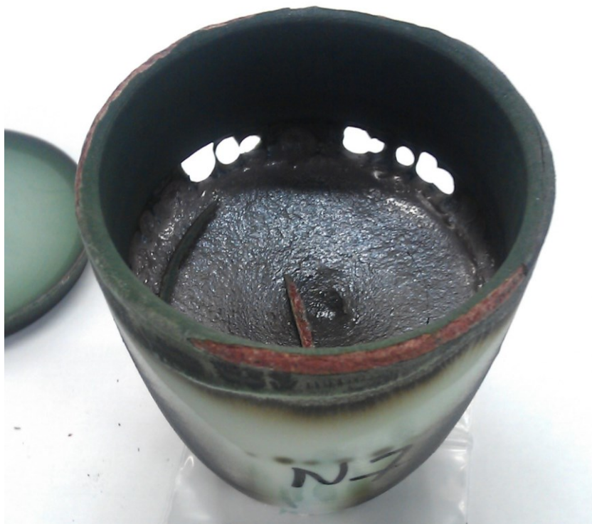
Abbildung 264: Tiegeldurchbruch im Versuch 240912 N7
