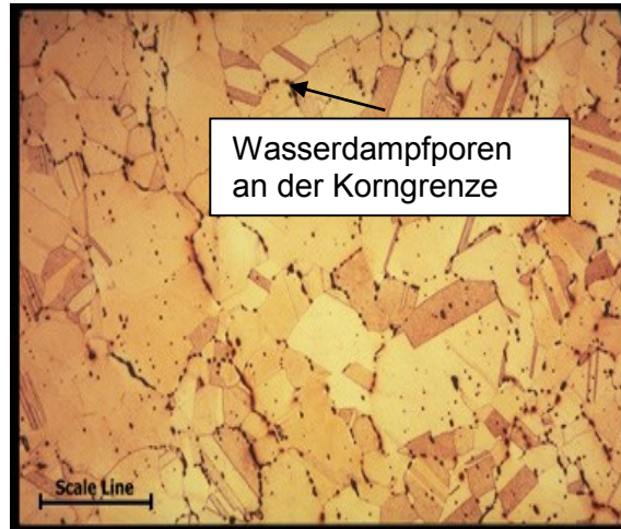
Abbildung 6: Wasserstoffsprödigkeit bei ETP-Kupfer [12]
