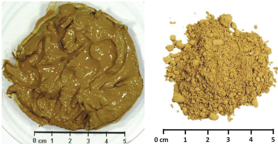
Abbildung 3-2: Rechts: Getrockneter hydrometallurgischer Zinkrückstand Links: Anlieferungszustand des hydrometallurgischen Zinkrückstands
