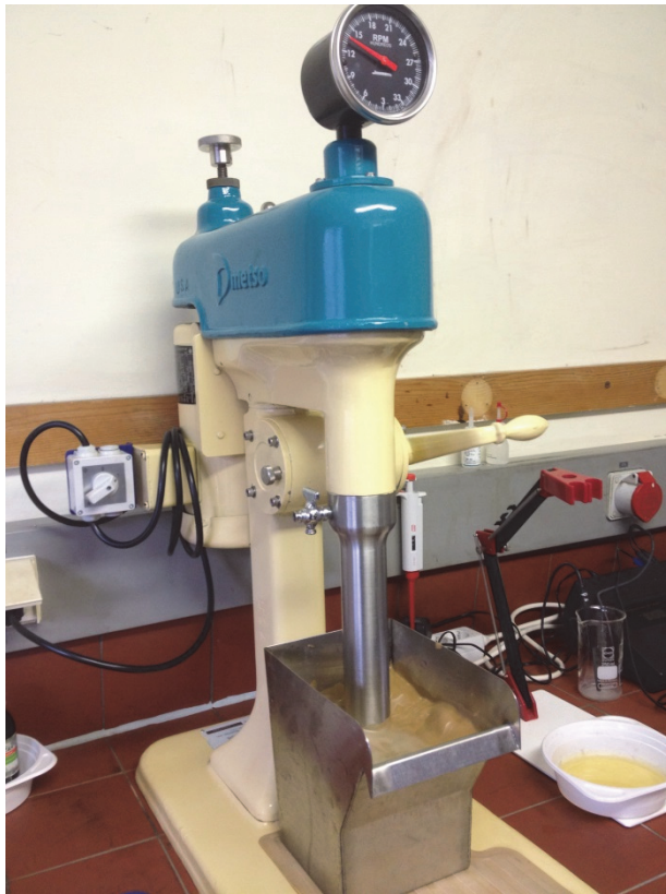
Abbildung 4-6: Flotationsmaschine des Herstellers metso mit 2,5 l Zelle sowie das Ablaufschema des Flotationsversuchs_4 und ein Schaumprodukt
