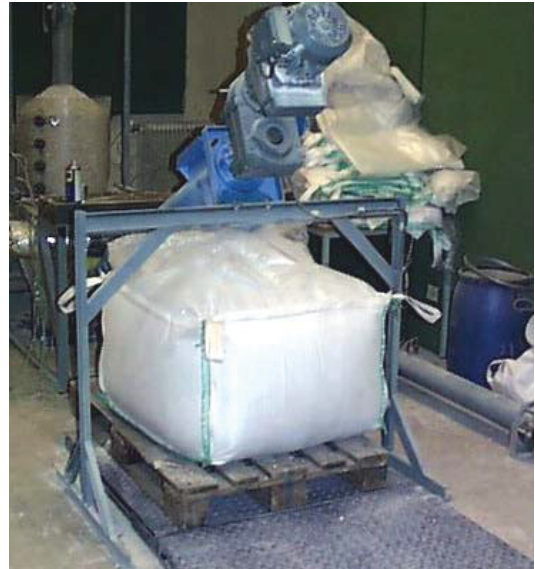
Abbildung 52: Aufgeblähter Big Bag bei Durchgasung der Anlage
