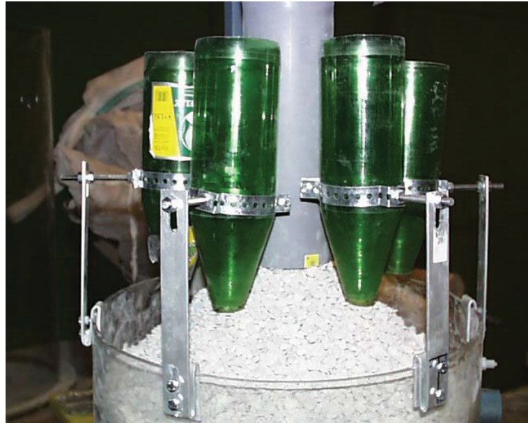
Abbildung 134: Chargiervorrichtung für das Paraffingranulat
