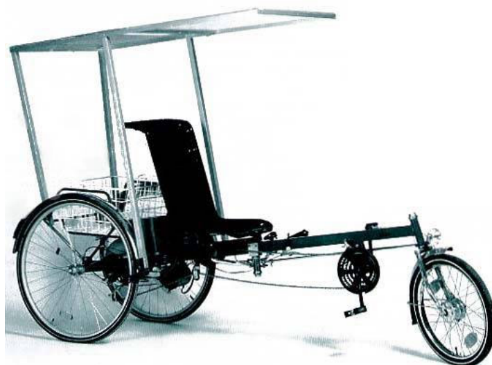
Bild 2.5: Solarliegedreirad des deutschen Vereins ASK
