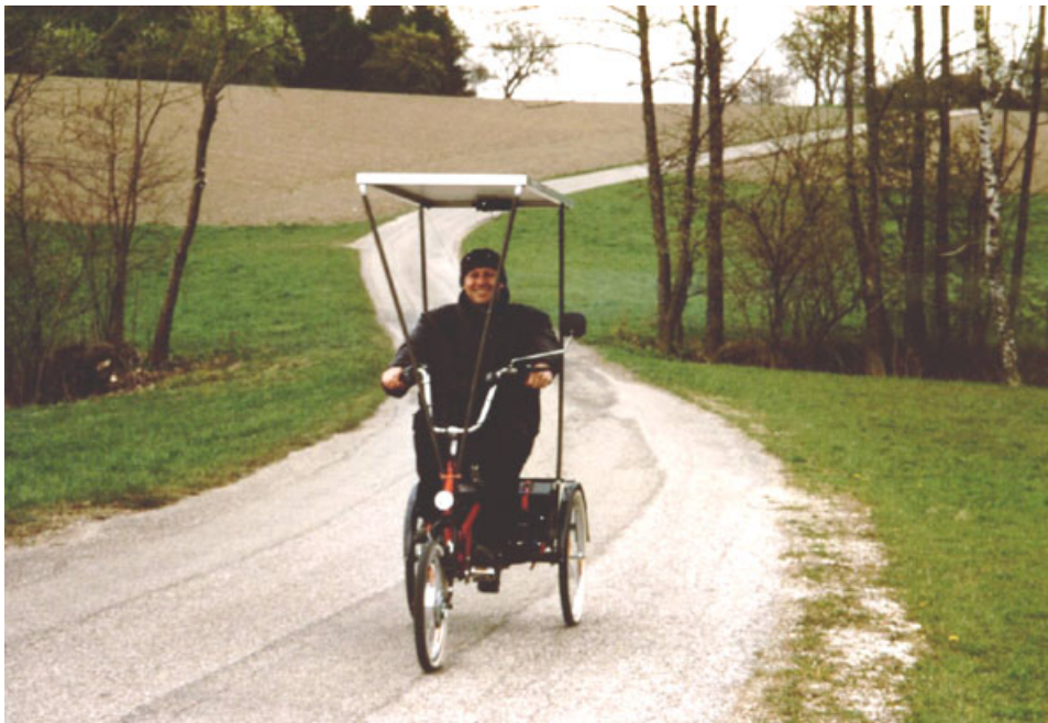
Bild 6.2: Der Prototyp I – ein „echtes“ Solarfahrrad
