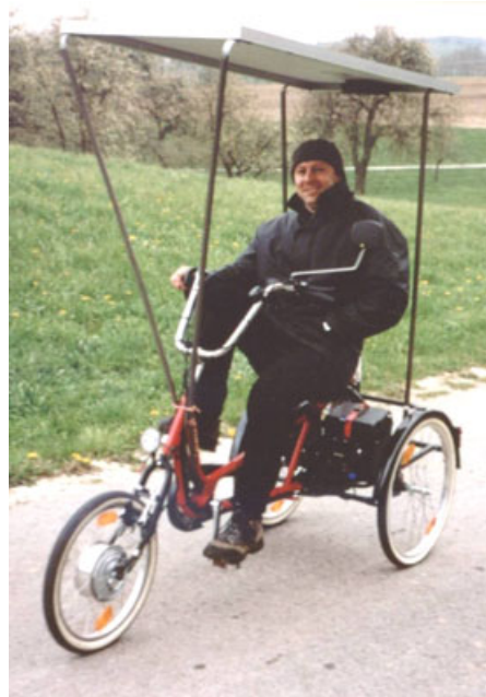
Bild 6.1: Der Prototyp I – ein „echtes“ Solarfahrrad (8,8% Steigung)
