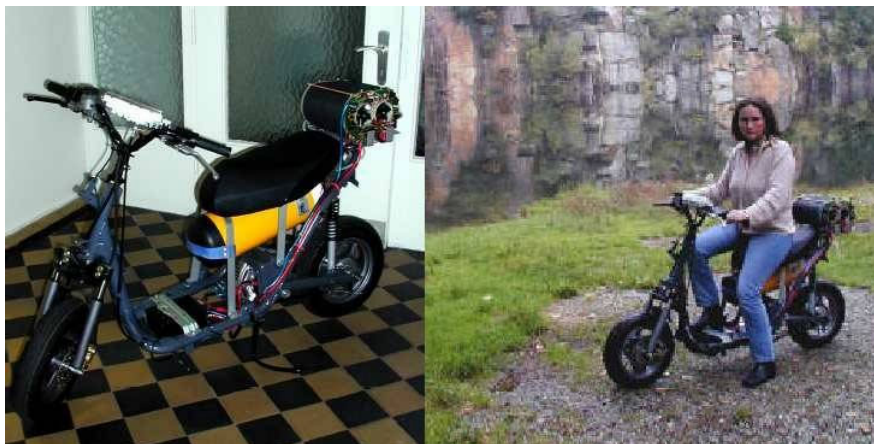
Bild 2.9: Mit Wasserstoff betriebenes Brennstoffzellenmoped
