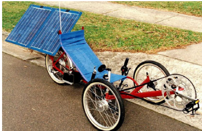
Bild 2.1: Solardreirad von Greenspeed mit Radnabenmotor von Heinzmann [2.2]
