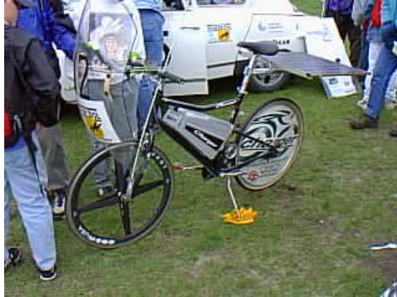
Bild 2.3: Einfaches Solarrennrad, das für ein Rennen auf geringes Gewicht und Windschlüpfrigkeit optimiert wurde.
