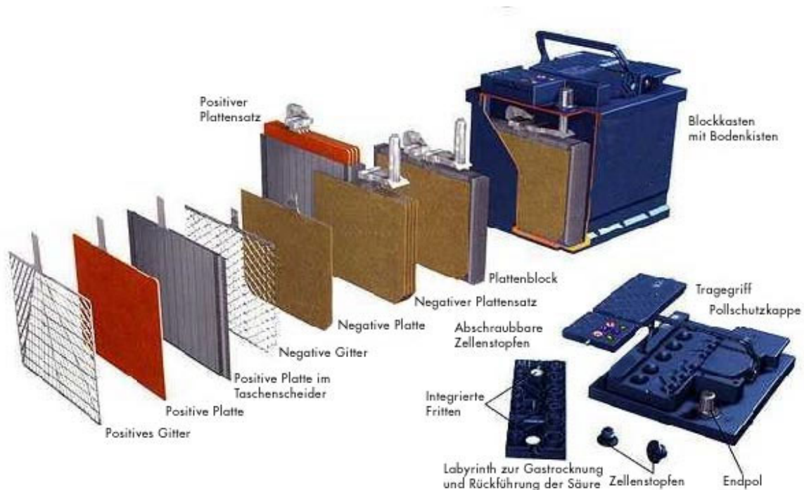
Bild 4.9: Aufbau einer Blei-Säure-Batterie [4.18]
