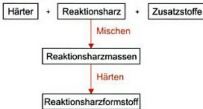
Abb. 2.4: Verfahrensschritte in der Reaktionsharztechnologie [14].
