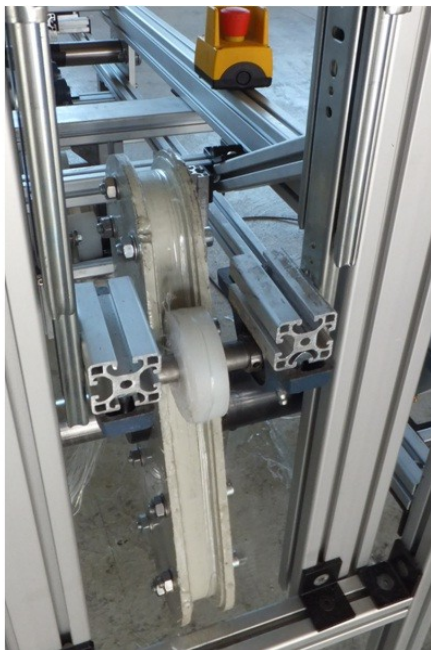
Abb. 4.13: Prototypenanlage: Bereich Anpressrolle.
