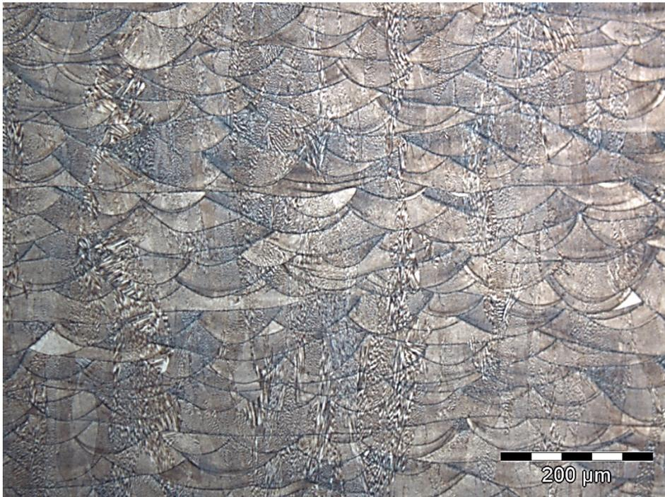
Abbildung 2.8: Querschnitt – SLM Bauteil (Werkstoff: IN718)
