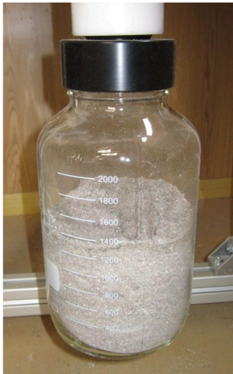
Abbildung 24: Zerkleinertes Material nach der Pulverisette
