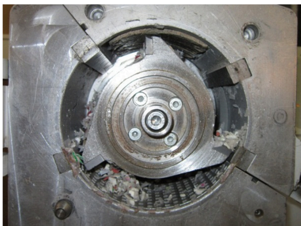
Abbildung 21: V.l.: Rückstände am Siebdurchlass und herausgedrücktes Probenmaterial bei der Schneidmühle
