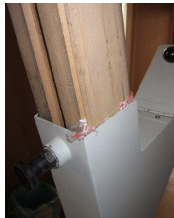
Abbildung 21: V.l.: Rückstände am Siebdurchlass und herausgedrücktes Probenmaterial bei der Schneidmühle
