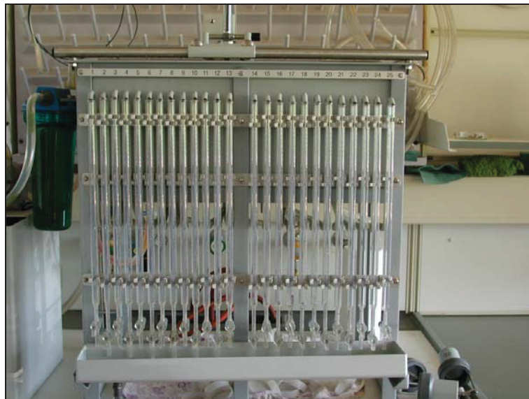
Abbildung 4.3: ICW Laboratory Permeameter zur Bestimmung der gesättigten Wasserleitfähigkeit
