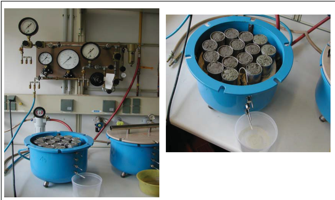
Abbildung 4.4: pF - Drucktöpfe zur Bestimmung der Porenvolumina
