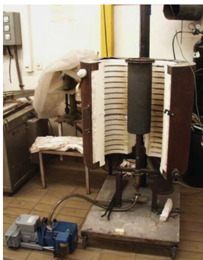
Abb. 4.17 Röhrenofen vertikal mit Pumpe
