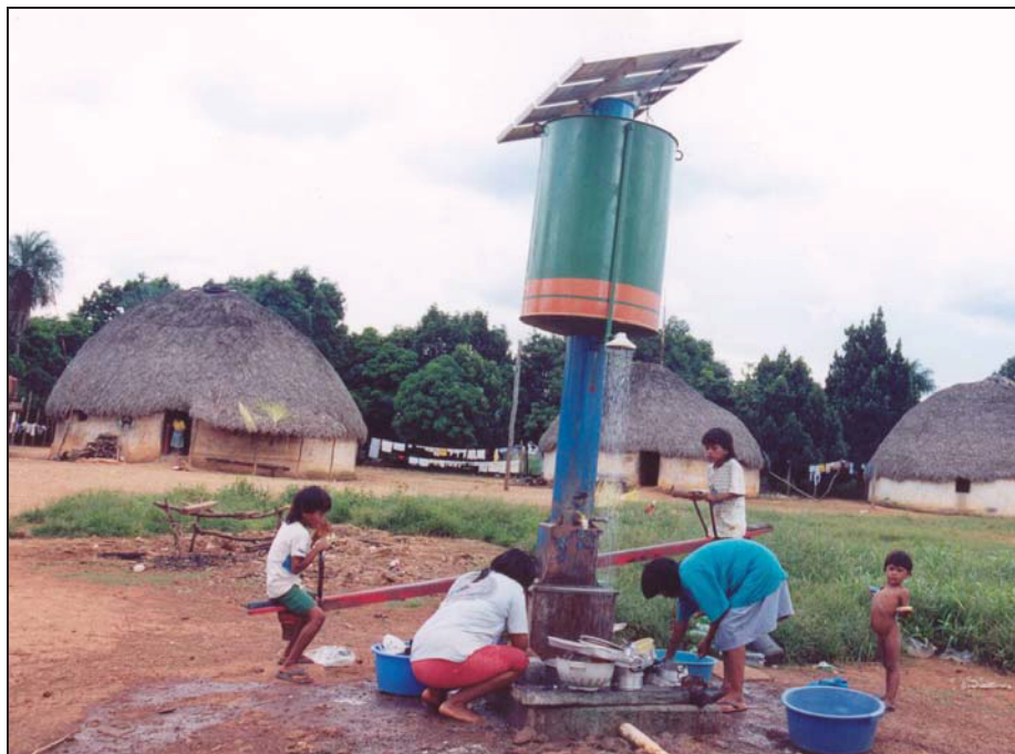
Abbildung 45: Schaukelpumpe der Salesianer zur Grundwasserförderung (JUGEND EINE WELT, 2003).
