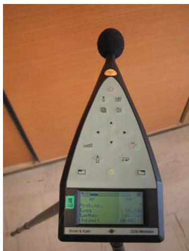
Abbildung 4.1: Messgerät Bauart 2238 der Firma Brüel & Kjær
