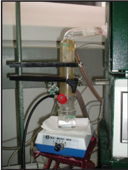
Abbildung 2.3: Einrichtung zur TIC – Bestimmung
