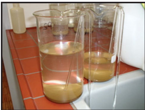
Abbildung 3.2: Absetzung der Fraktion < 0,063 mm
