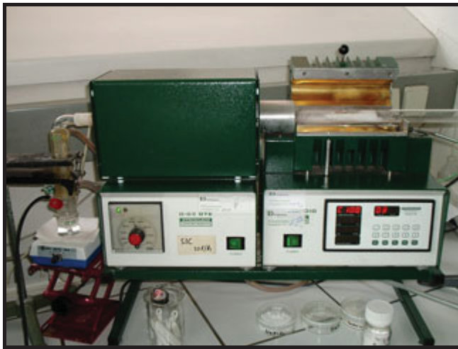
Abbildung 2.1: Verbrennungseinheit des TOC – Analysators
