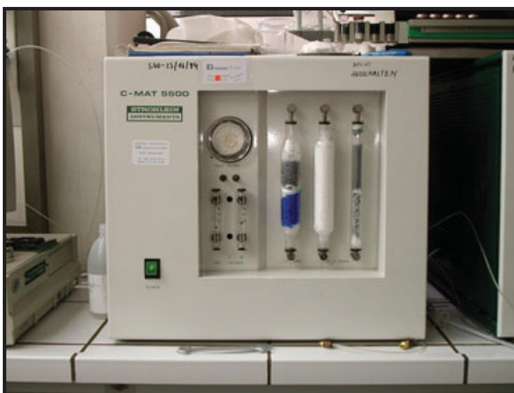
Abbildung 2.2: Analysator des TOC – Analysators
