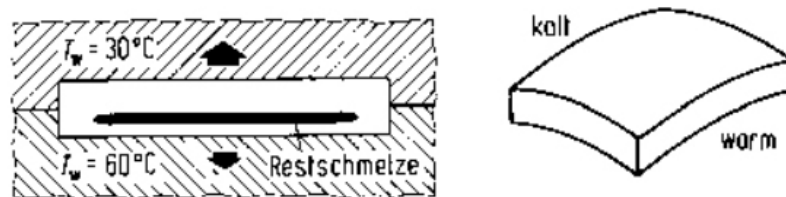
Abbildung 2.25: Verzug einer Platte bei ungleichmäßiger Wärmeabfuhr durch unterschiedliche Temperaturen der Werkzeughälften [52].
