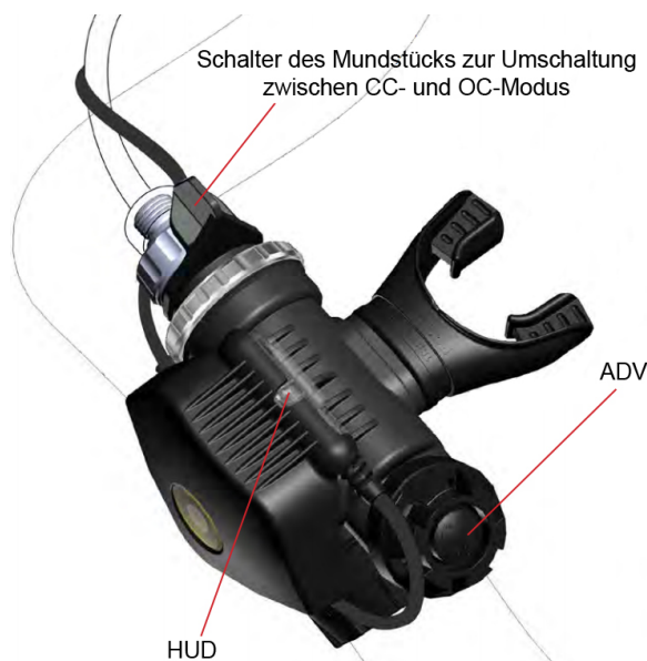
Abbildung 2.4: Mundstück des Poseidon MKVI [42]. Die Kreislauf-Anschlüsse mit den Richtungsventilen befinden sich auf der Unterseite des Mundstücks (in der Abbildung nicht sichtbar).
