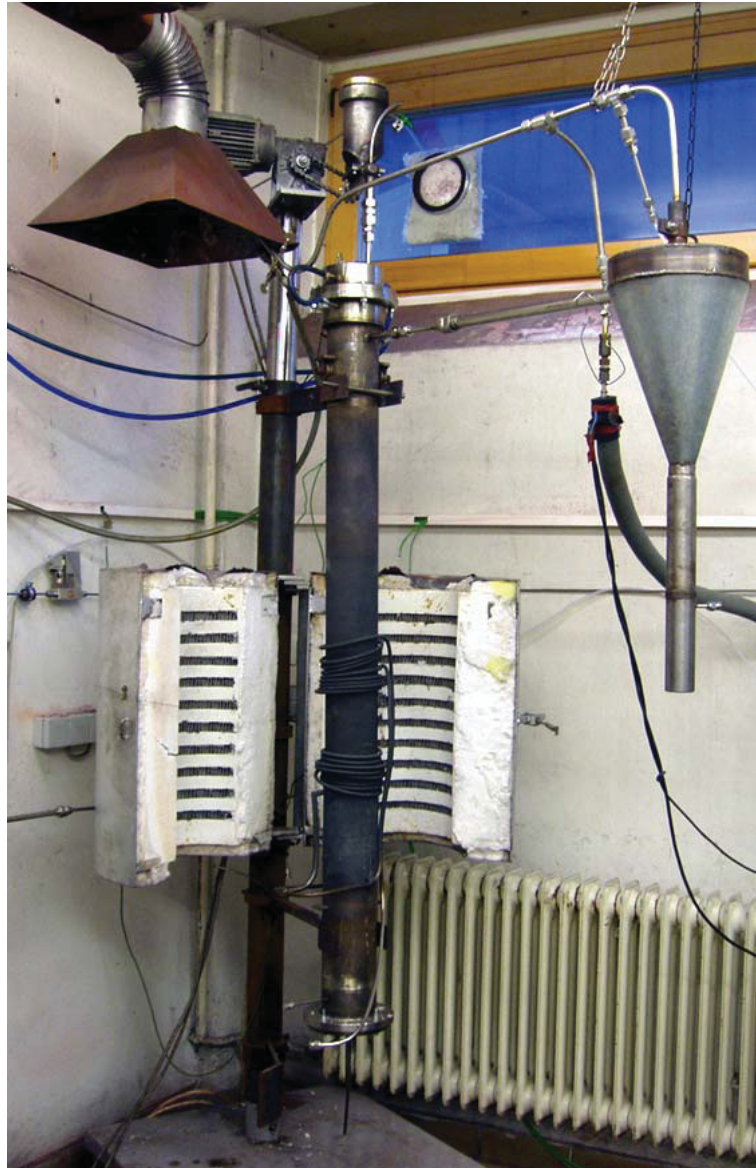
Abbildung 4.52: Wirbelschichtreaktor mit geöffnetem Schalenofen
