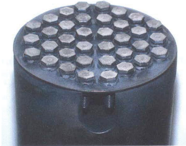
Abbildung 4.53: Innenrohr mit Gasverteilungsboden
