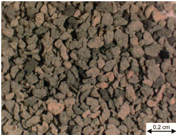
Abbildung 4.60: Asche KS mittel, \lambda_{\text{tat.}} = 0,9 , Aschegehalt von 98,95 %
