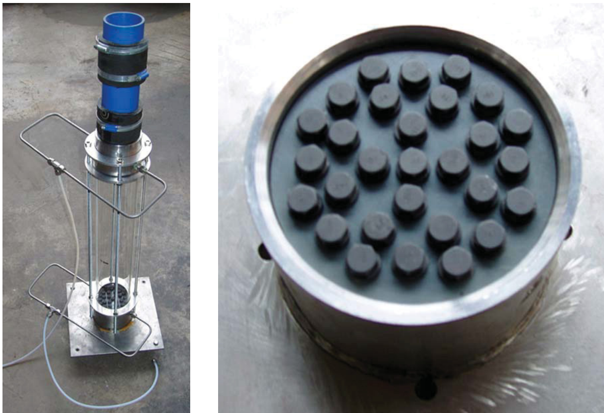
Abbildung 4.43: Versuchsanordnung und Gasverteilungsboden
