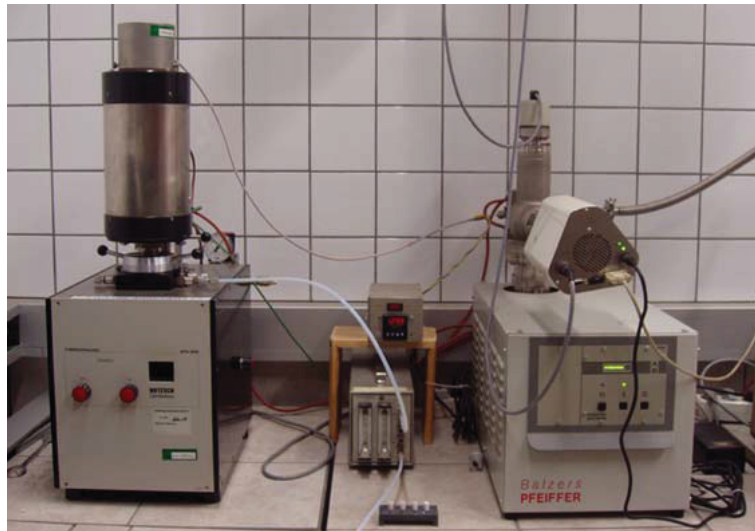
Abbildung 4.7: STA 409 gekoppelt mit einem Quadrupol-Massenspektrometer
