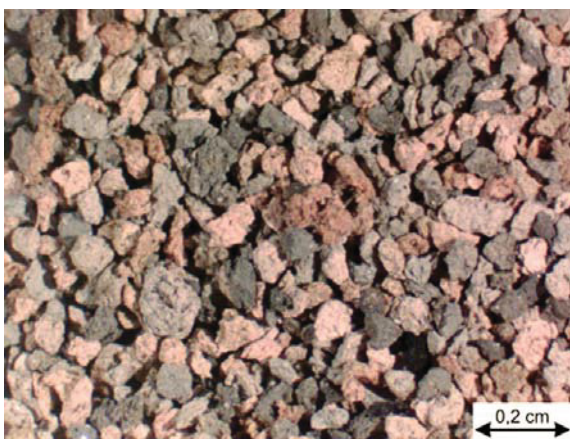
Abbildung 4.62: Asche KS mittel, \lambda_{\text{tat.}} = 1,2 , Aschegehalt von 99,74 %
