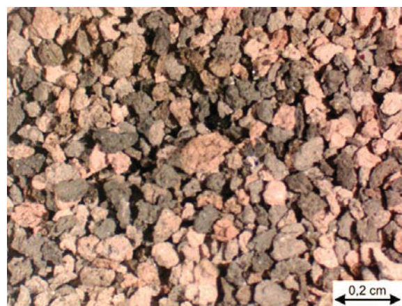
Abbildung 4.63: Asche KS mittel, \lambda_{\text{tat.}} = 1,3 , Aschegehalt von 99,78 %
