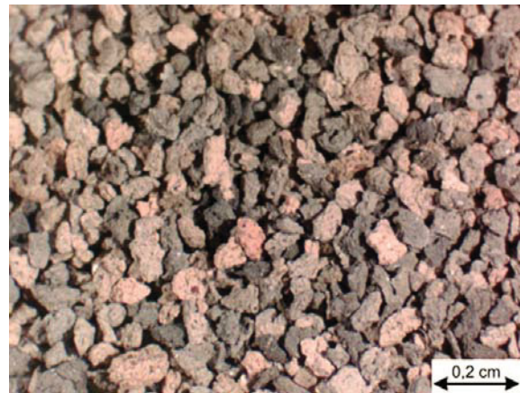
Abbildung 4.61: Asche KS mittel, \lambda_{\text{tat.}} = 1,0 , Aschegehalt von 99,59 %
