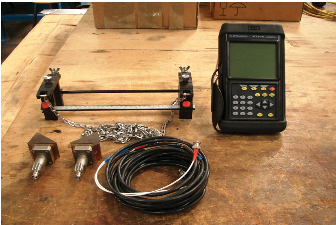
Abbildung 5: Ultraschalldurchflussmessgerät PT 878 mit Zubehör
