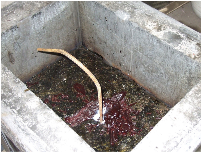
Gewonnene, erstarrte Schlacke in Abstichwanne (linkes Bild) und Filterstaub (rechtes Bild) aus „Kampagne 13.07.2010“ [32]
