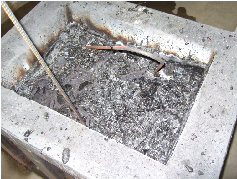
Gewonnene, erstarrte Schlacke in Abstichwanne (linkes Bild) und Filterstaub (rechtes Bild) aus „Kampagne 14.07.2010“ [32]
