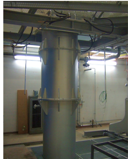
Stahlbau des Konverters im OG des Technikums mit Übergangsknie zu Quenche (linkes Bild); Stahlbau der Quenche im EG des Technikums (rechtes Bild) [32]
