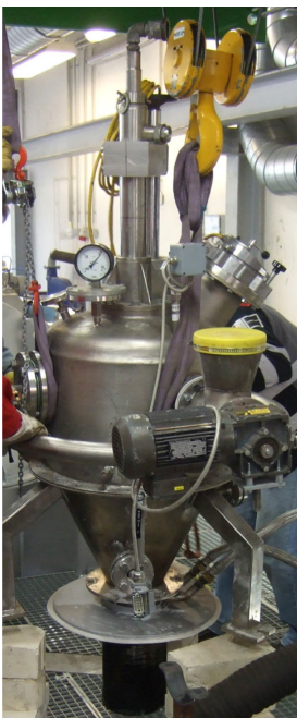
Hauptbrenner bzw. Dosier- und Mischzyklon mit wassergekühltem Fall- bzw. Drallrohr (linkes Bild); Hauptbrenner bzw. Dosier- und Mischzyklon – Untersicht (rechtes Bild) [32]
