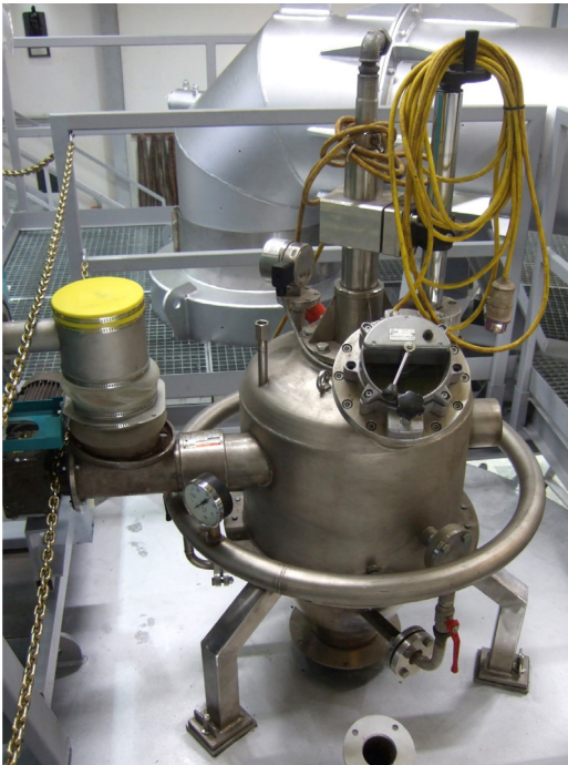
Hauptbrenner bzw. Dosier- und Mischzyklon mit Ringleitung zur Eindüsung von Sekundärsauerstoff und Dreibeingestell zur Befestigung am Deckel der Brennkammer [32]
