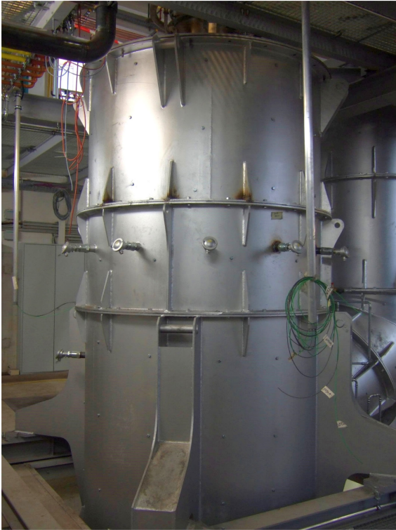
Stahlbau der Brennkammer im EG des Technikums mit installierten Thermoelementen (linkes Bild); Stahlbau im EG des Technikums von Brennkammer, Übergangsknie von Brennkammer zu Steigrohr und des Steigrohrs (rechtes Bild) [32]
