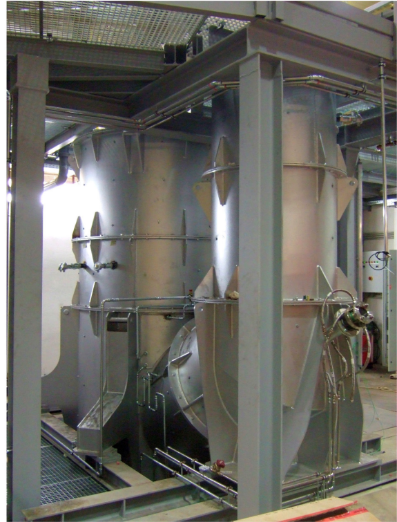
Stahlbau der Brennkammer im EG des Technikums mit installierten Thermoelementen (linkes Bild); Stahlbau im EG des Technikums von Brennkammer, Übergangsknie von Brennkammer zu Steigrohr und des Steigrohrs (rechtes Bild) [32]
