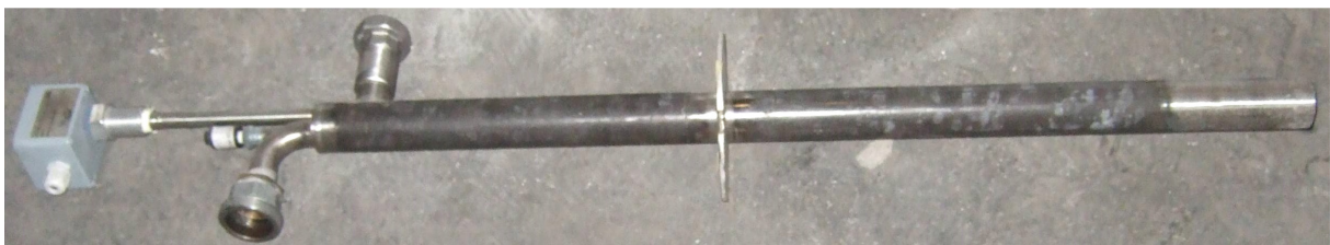
Herausgezogener Stützbrenner der Flash-Reaktor Pilotanlage [32]
