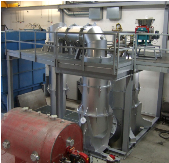
Stahlbau der Flash-Reaktor Pilotanlage ohne (linkes Bild) und mit (rechtes Bild) installiertem Staubfördersystem [32]
