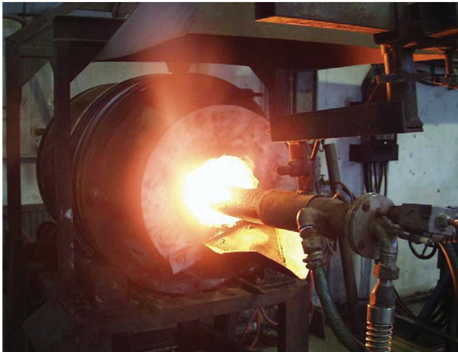
Abb. 30: TBRC (Anlage ARP GmbH, Leoben-Donawitz)
