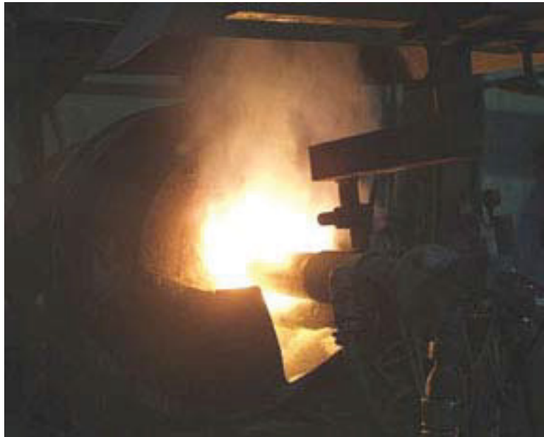
Abb. 31: Rauchentwicklung am Beginn der Ausdampfphase
