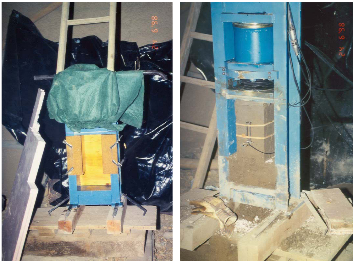
Abb. 24.: Schalung vor dem Einspritzvorgang (links), Instrumentierter Probenkörper im Pressenrahmen (rechts) [1]
