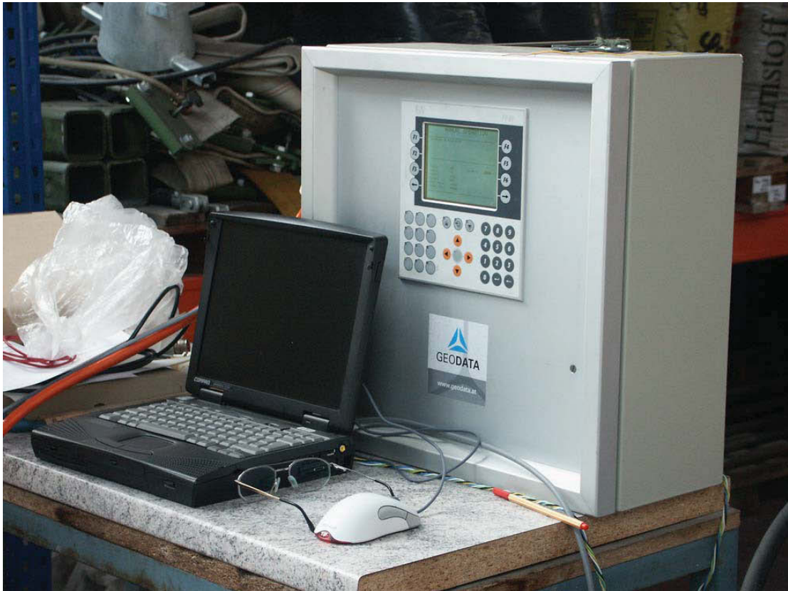
Abb. 27.: Programmier- und Datenspeichereinheit mit angeschlossenem Notebook
