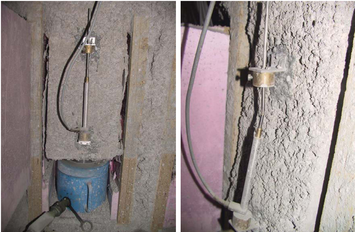
Abb. 37.: Probe Birgl 01 beim Ausbau der Versuchsanlage
