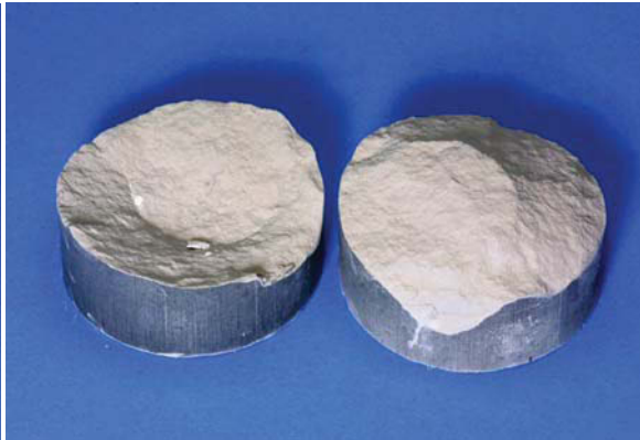
Abbildung 9: Rohstoffgemenge AN50; nach dem Verpressen wurde die Probe gebrochen
