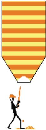
Abbildung 7-1: Brückenbildung im Sturzsacht / Silo
