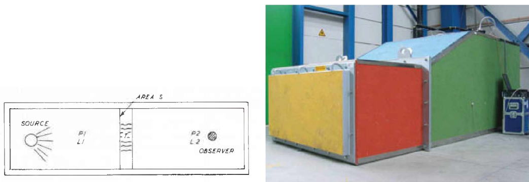
Abb. 3.12: Prinzip zur Messung der Schalldämmung [22], rechtes Bild aus [23].
