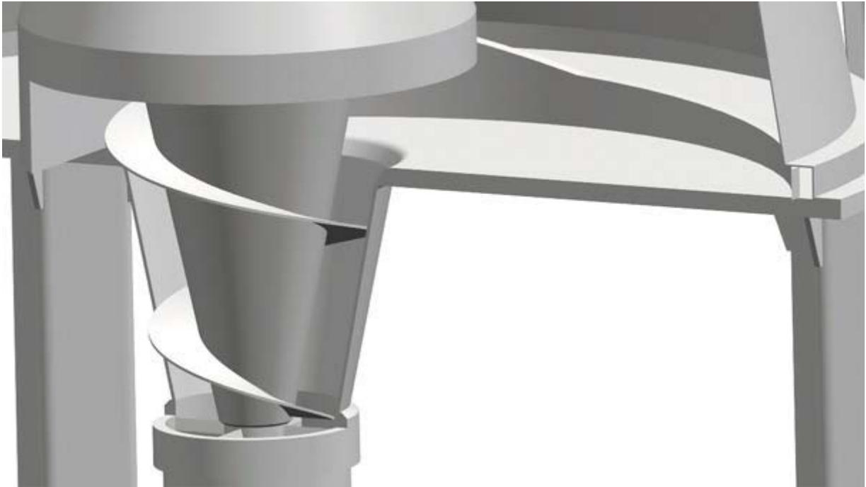
Abb. 4-9: Schnecke im Bereich zwischen Räumarmaustrag und Lagerhalterung
