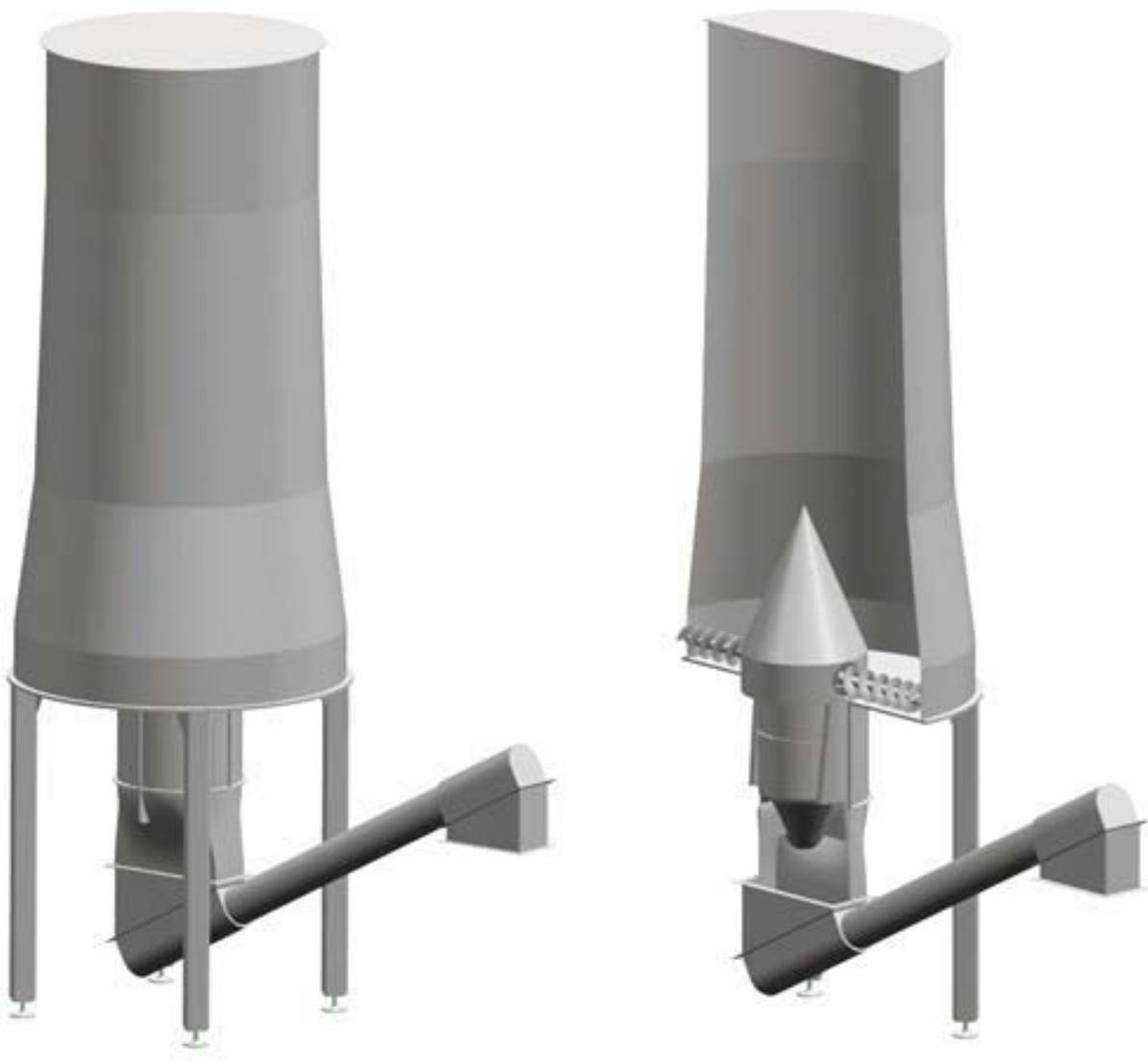
Abb. 4-12: Bunker mit zwei rotierende Schneckenarmen
