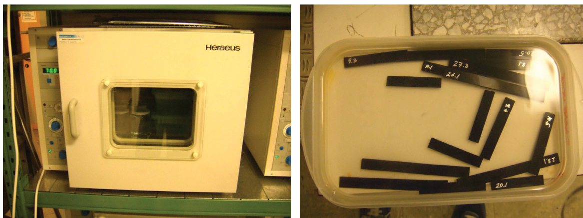
Abb. 3.6: Temperierschrank und Kunststoffbox mit Wasser für die Feuchte-konditionierung im Dampfbad.
