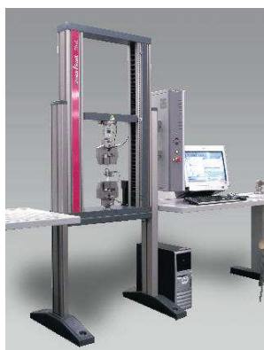
Abb. 3.7: Universalprüfmaschine Zwick Roell Z010 (aus Zwick Roell, 2007).
