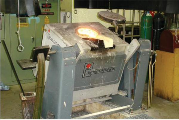
Abbildung 3-1: Induktionsofen am Institut für Metallurgie
