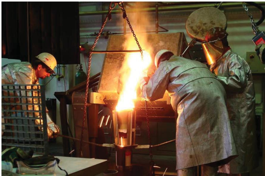
Abbildung 3-3: Abguss der Schmelze mittels vorgewärmten Trichter
