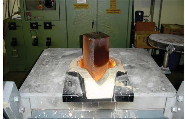
Abbildung 3-2: Induktives Aufschmelzen des Einsatzmaterials
