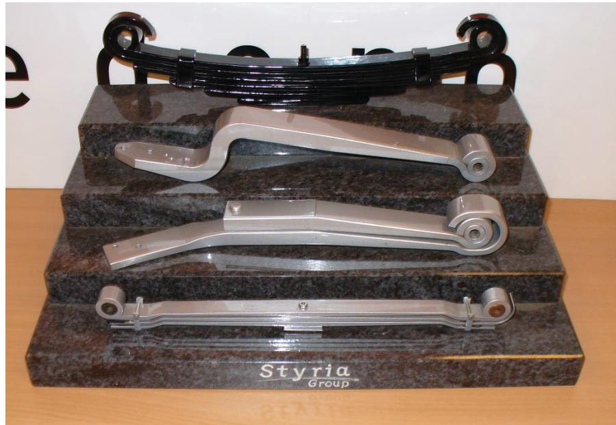
Abbildung 2-20: Diverse Blatt- und Parabelfedern zur Fahrzeugaufhängung
