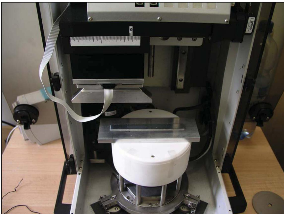
**Abb. 3.4:** Foto des für die Messungen fertig aufgebauten PCCL Tribometers.
