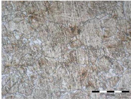
**Abbildung 5.16:** Nitalätzung der bei 790 °C umgeformten Probe des RN22VNB
