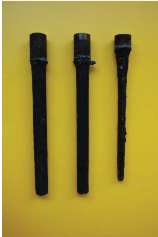
Abbildung 8.24: Proben nach 10-stündiger Reaktionszeit, Versuch 2, Aluminiumlegierung 226, T=750°C, W360N (links), W360 (Mitte), W315N (rechts)
