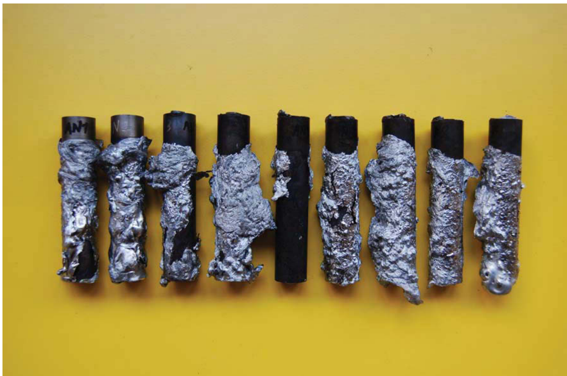
Abbildung Ba1: W300N – Aluminiumlegierung 226 (Reaktionszeiten von links nach rechts: 20, 40, 60, 300, 600, 1200, 1800, 2400 und 3000 sec)
