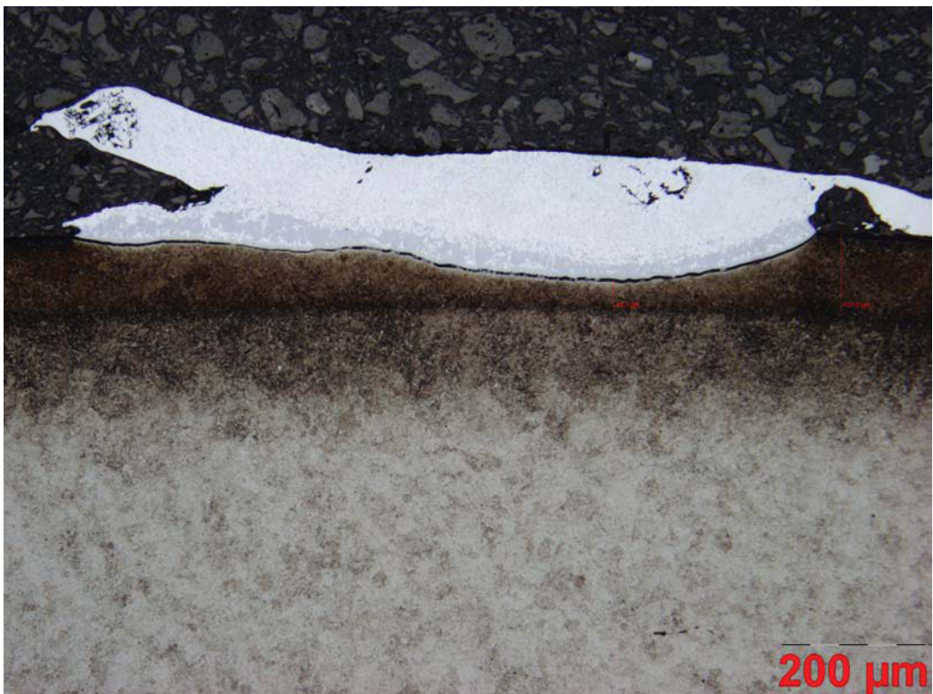
Abbildung Bd13: W360N, Aluminiumlegierung 226, Reaktionszeit: 2400 sec
