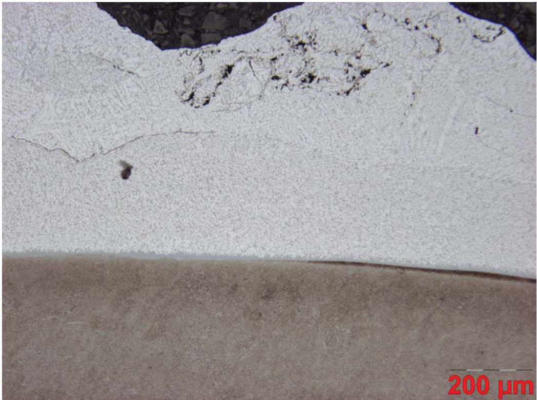
Abbildung Bd25: W300N, Aluminiumlegierung Magsimal-59, Reaktionszeit: 2400 sec
