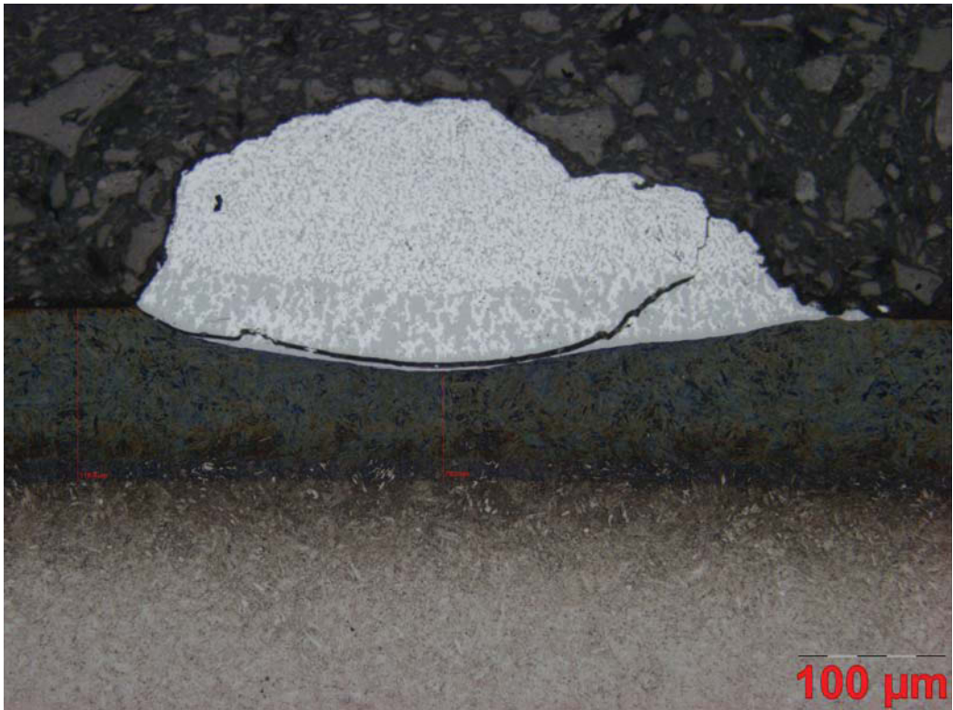
Abbildung Bd8: W315N, Aluminiumlegierung 226, Reaktionszeit: 1200 sec
