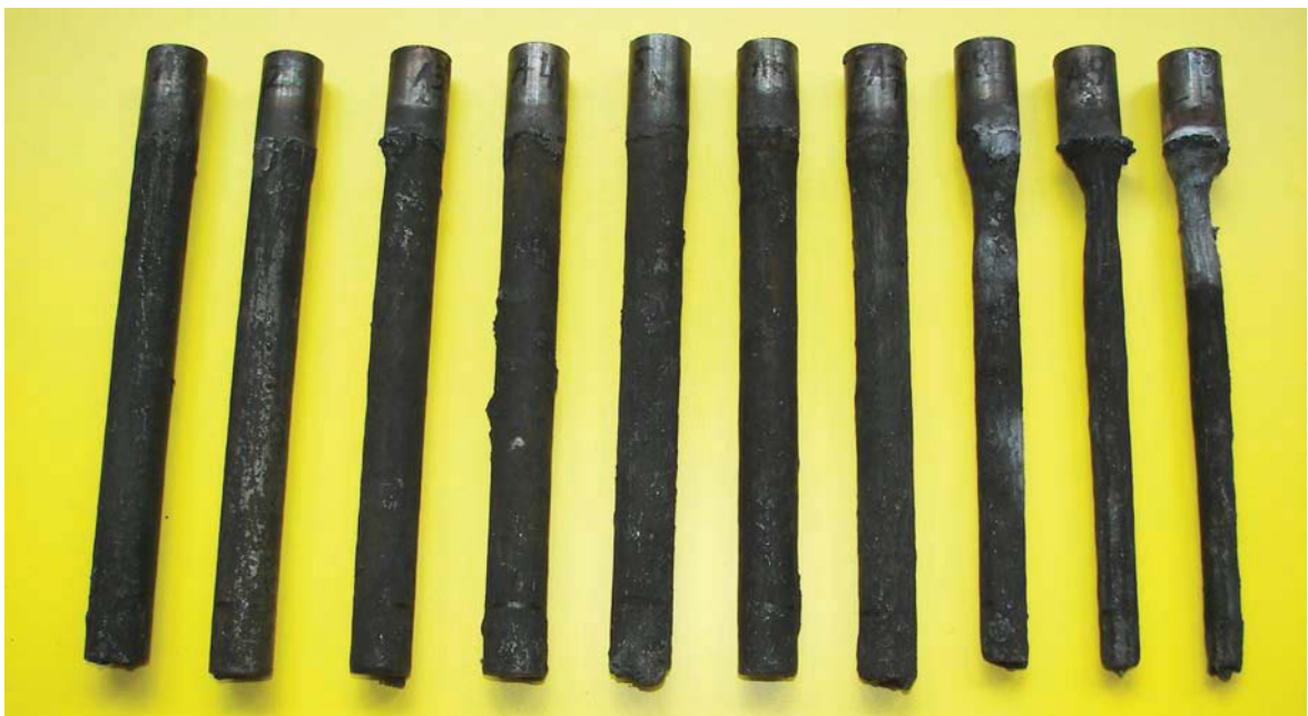
Abbildung Aa5: Zusatzversuch 1, W300, Aluminiumlegierung 226, T=750°C, Versuchsdauer von links nach rechts: 1, 2, 3, 4, 5, 6, 8, 21.5, 32, 36 Stunden
