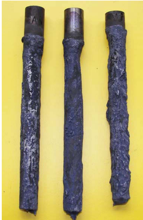
Abbildung 8.27: Proben nach 10-stündiger Reaktionszeit, Versuch 3, Aluminiumlegierung Magsimal-59, T=750^{\circ}\text{C} , W300N (links), W300 (Mitte), W315 (rechts)
