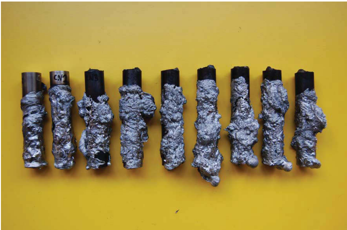
Abbildung Ba 3: W360N – Aluminiumlegierung 226 (Reaktionszeiten von links nach rechts: 20, 40, 60, 300, 600, 1200, 1800, 2400 und 3000 sec)
