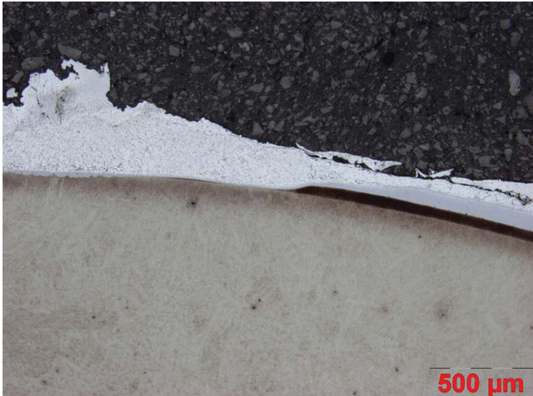
Abbildung 8.9: W300, Aluminiumleg. Magsimal-59, Reaktionszeit:1800sec, Schädigung: schwer
