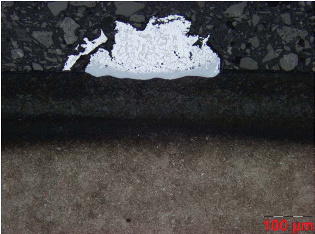
Abbildung Bd35: W360N, Aluminiumlegierung Magsimal-59, Reaktionszeit: 300 sec
