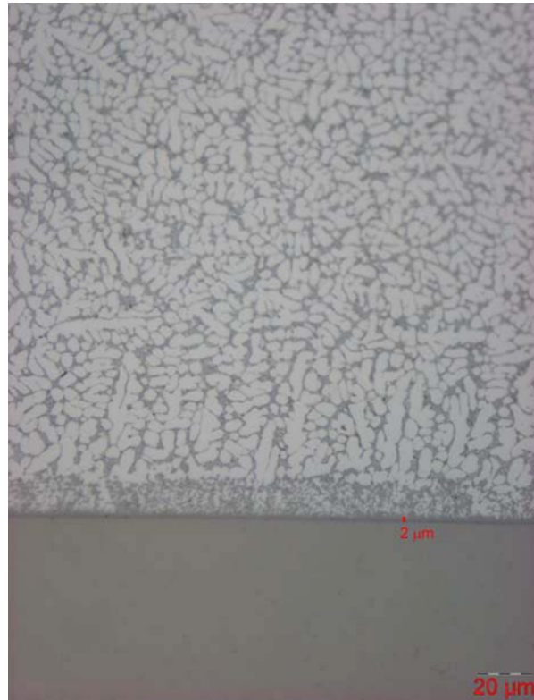
Abbildung Bb11: W315, Aluminiumlegierung 226, t=40 sec, T=750°C
