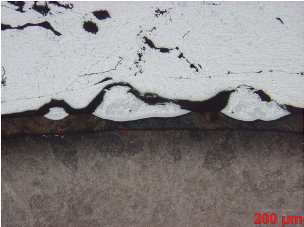
Abbildung Bd6: W300N, Aluminiumlegierung 226, Reaktionszeit: 2400 sec
