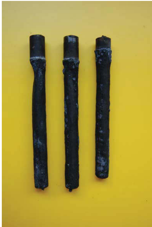
Abbildung Aa4: Versuch 4, W360N (links) W360 (Mitte) W315N (rechts), Aluminiumlegierung Magsimal-59, T=750°C, Versuchsdauer 10 h
