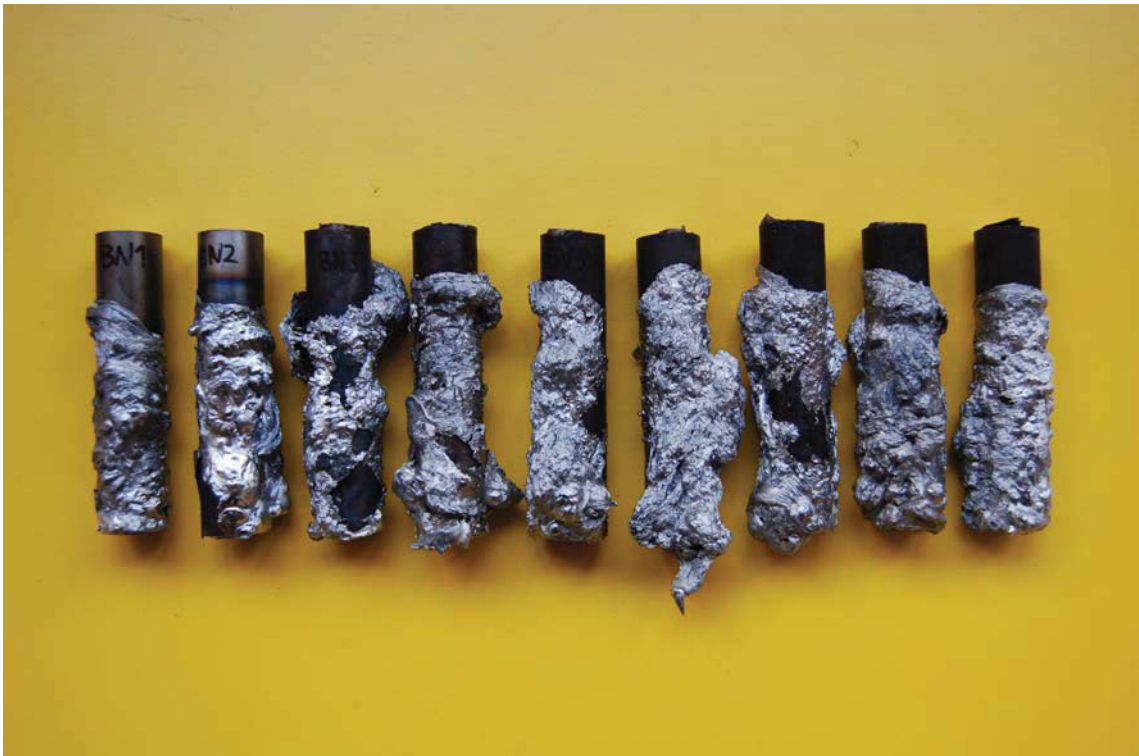
Abbildung Ba 2: W315N – Aluminiumlegierung 226 (Reaktionszeiten von links nach rechts: 20, 40, 60, 300, 600, 1200, 1800, 2400 und 3000 sec)
