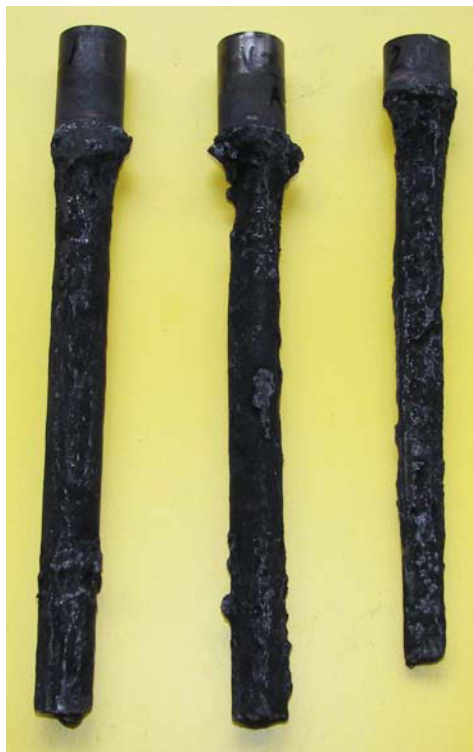
Abbildung 8.22: Proben nach 10-stündiger Reaktionszeit, Versuch 1, Aluminiumlegierung 226, T=750°C, W300N (links), W300 (Mitte), W315 (rechts)
