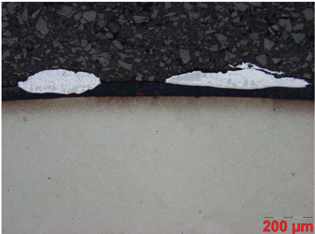
Abbildung Bd1: W300N, Aluminiumlegierung 226, Reaktionszeit: 300 sec
