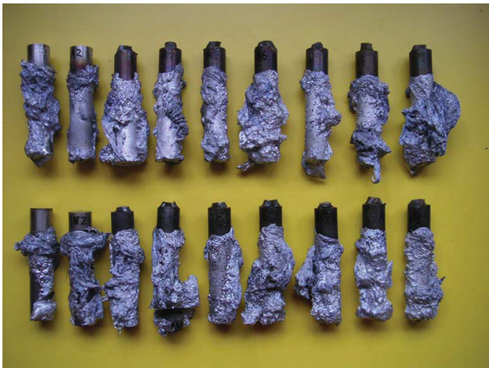
Abbildung Ba 5: W300 (oben) und W300N (unten) – Aluminiumlegierung Magsimal-59 (Reaktionszeiten von links nach rechts: 20, 40, 60, 300, 600, 1200, 1800, 2400 und 3000 sec)
