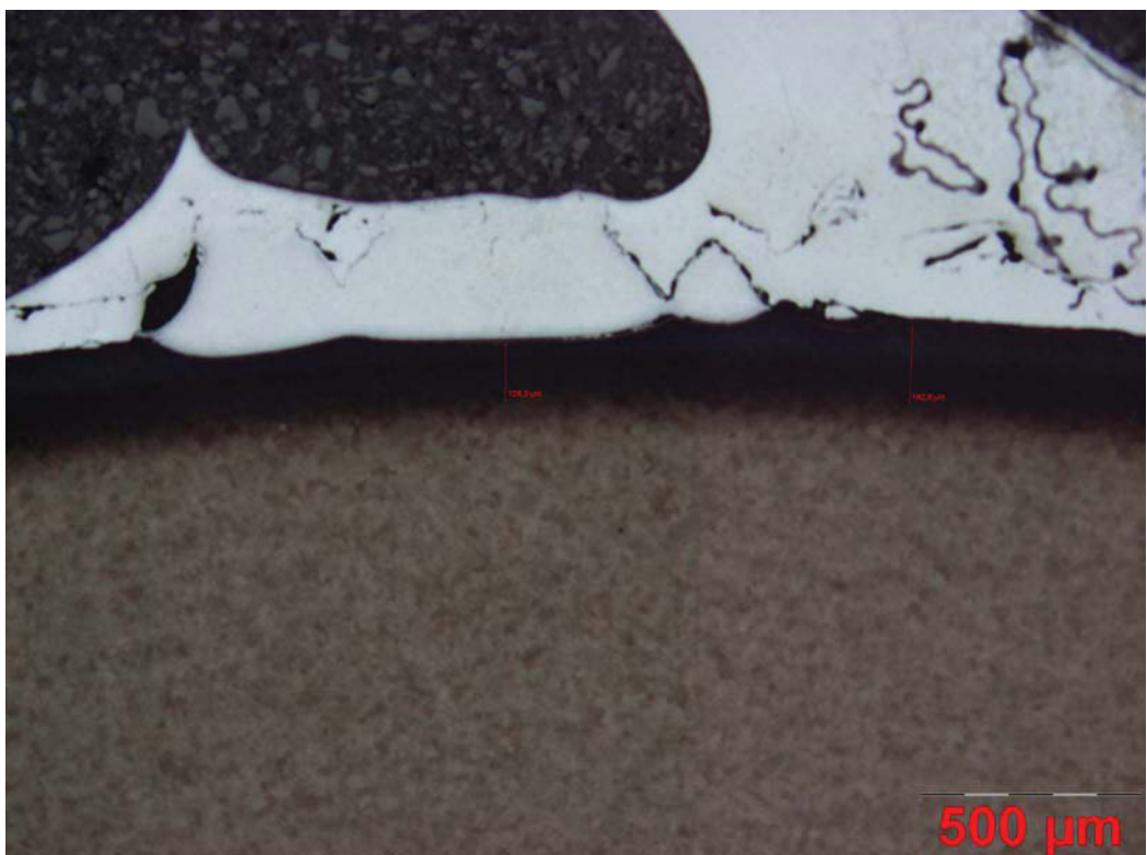
Abbildung Bd38: W360N, Aluminiumlegierung Magsimal-59, Reaktionszeit: 1800 sec
