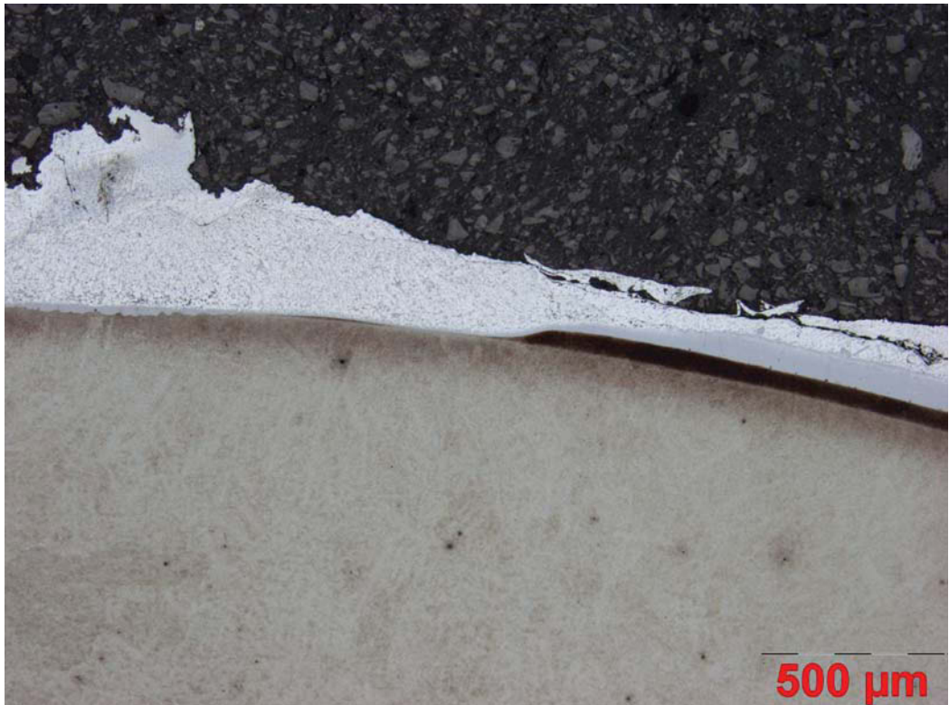
Abbildung Bd23: W300N, Aluminiumlegierung Magsimal-59, Reaktionszeit: 1800 sec
