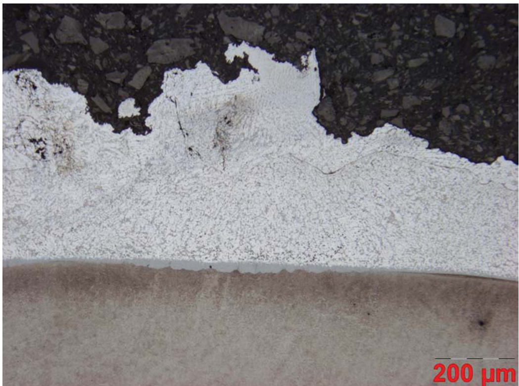
Abbildung Bd24: W300N, Aluminiumlegierung Magsimal-59, Reaktionszeit: 1800 sec
