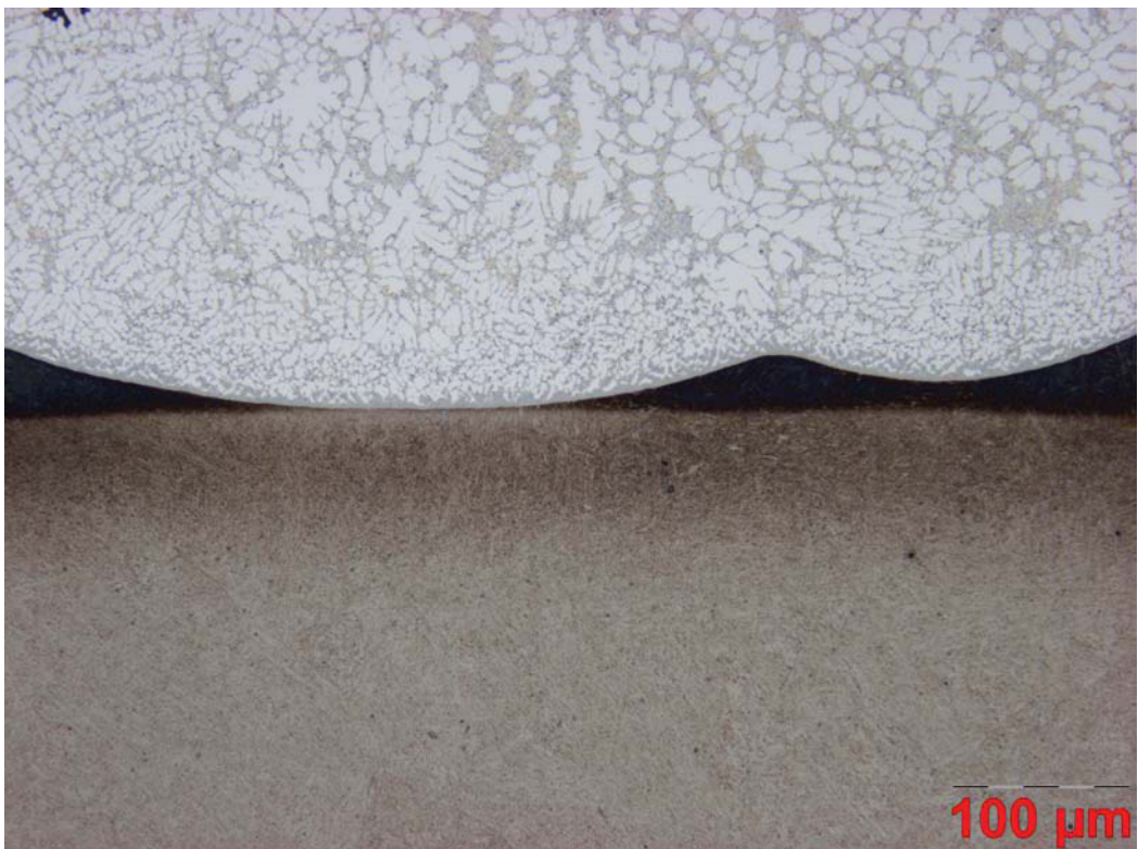
Abbildung Bd20: W300N, Aluminiumlegierung Magsimal-59, Reaktionszeit: 600 sec
