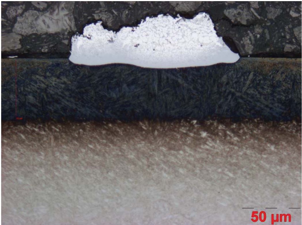
Abbildung Bd17: W300N, Aluminiumlegierung Magsimal-59, Reaktionszeit: 60 sec
