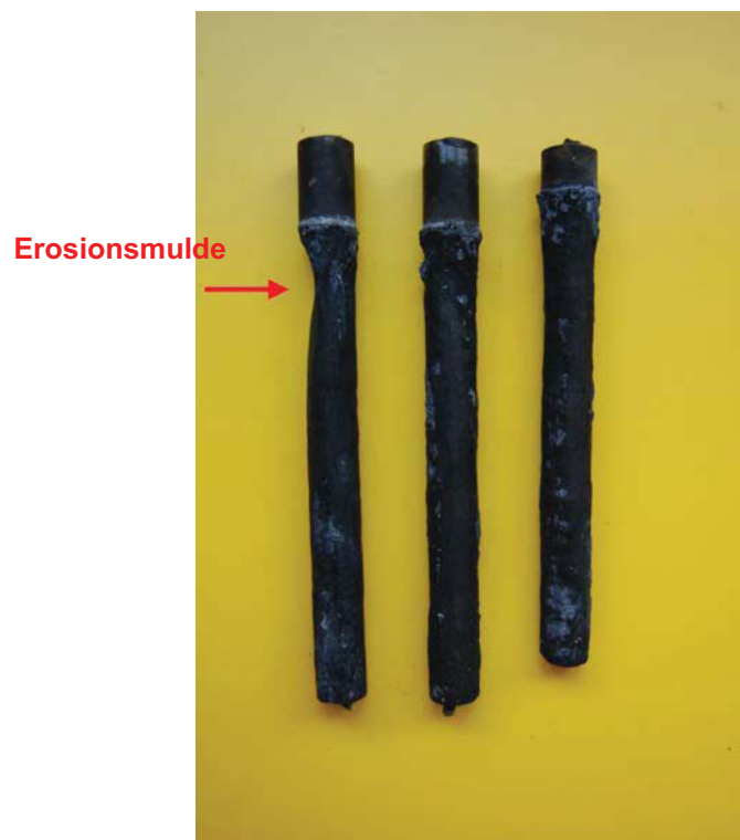
Abbildung 8.29: Proben nach 10-stündiger Reaktionszeit, Versuch 4, Aluminiumlegierung Magsimal-59, T=750°C, W360N (links), W360 (Mitte), W315N (rechts)
