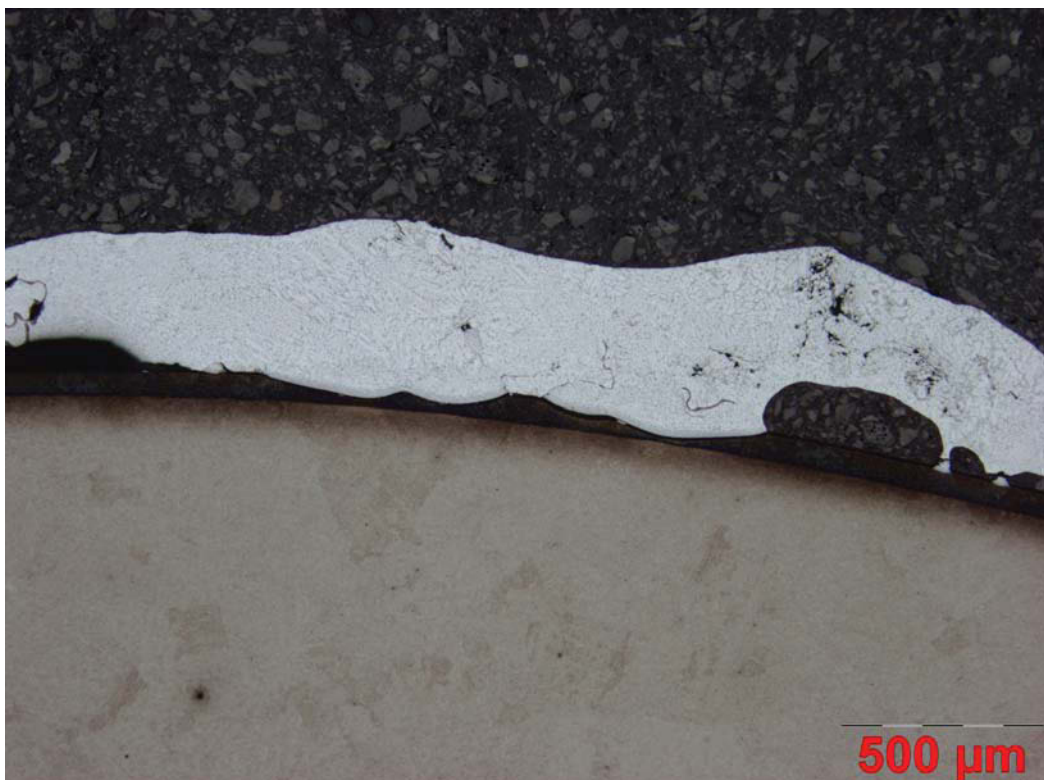
Abbildung 8.8: W300, Aluminiumleg. Magsimal-59, Reaktionszeit: 600sec, Schädigung: mittel
