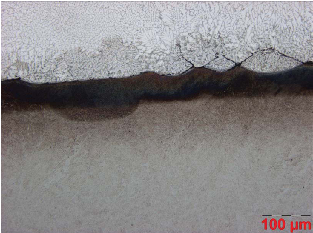
Abbildung Bd21: W300N, Aluminiumlegierung Magsimal-59, Reaktionszeit: 1200 sec
