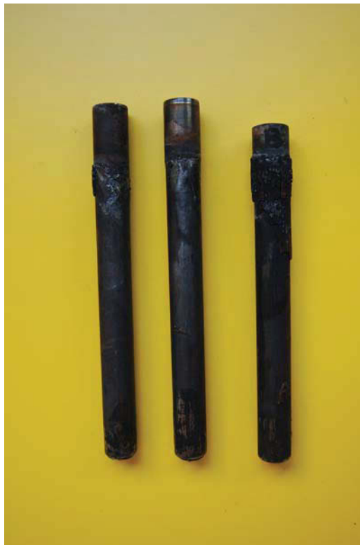
Abbildung Aa7: Zusatzversuch 2, W300N (links) W300 (Mitte) W315 (rechts), Aluminiumlegierung 226, T=610^{\circ}\text{C} , Versuchsdauer 10 h
