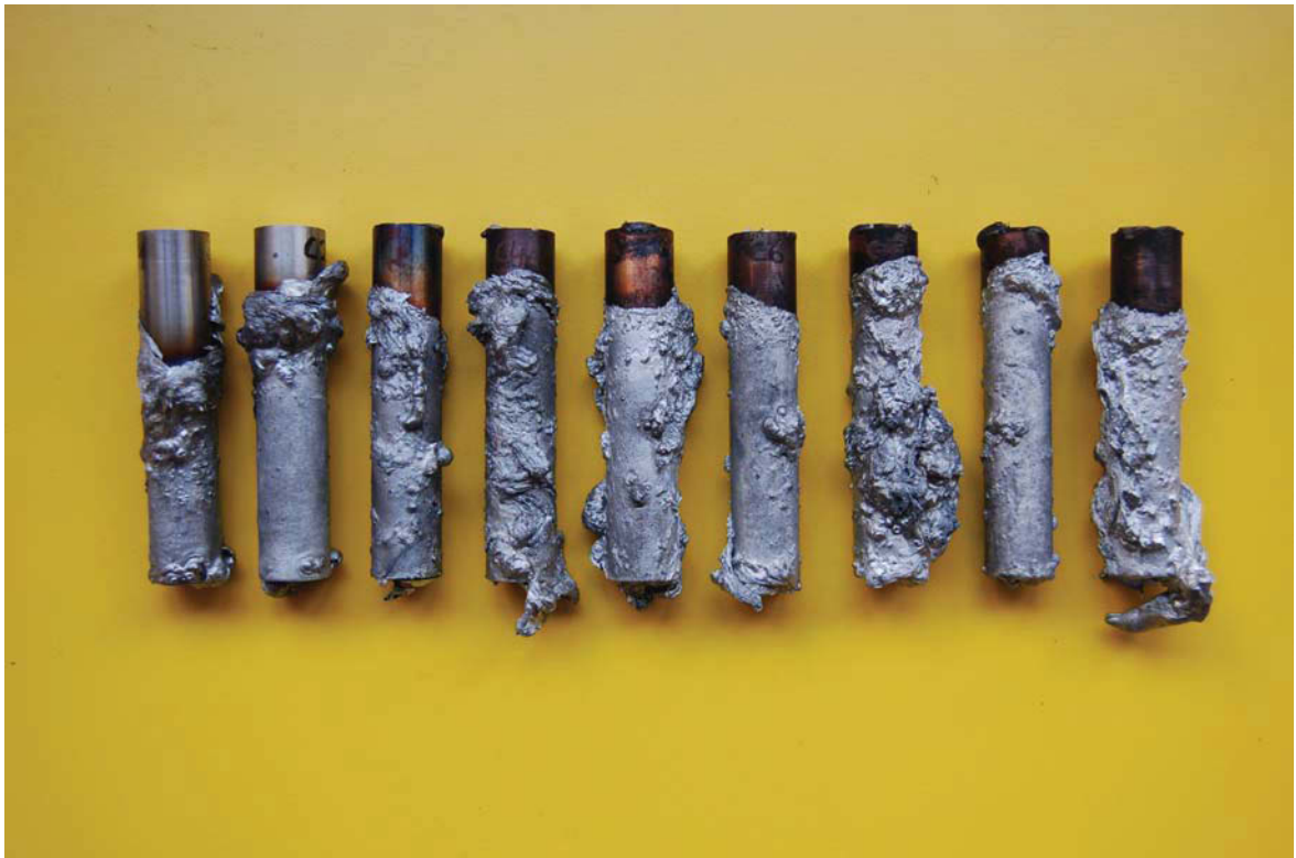
Abbildung Ba 4: W360 – Aluminiumlegierung 226 (Reaktionszeiten von links nach rechts: 20, 40, 60, 300, 600, 1200, 1800, 2400 und 3000 sec)
