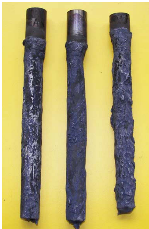
Abbildung Aa3: Versuch 3, W300N (links) W300 (Mitte) W315 (rechts), Aluminiumlegierung Magsimal-59, T=750°C, Versuchsdauer 10 h
