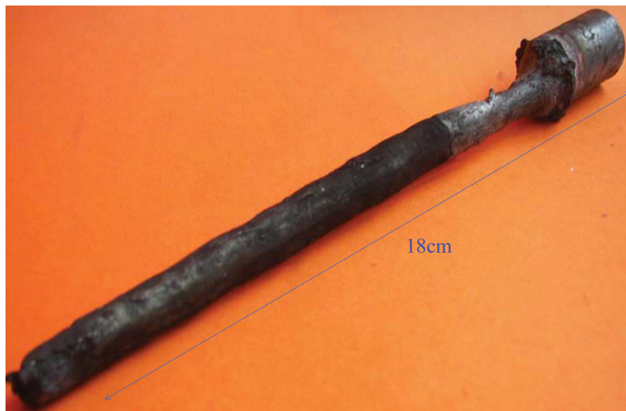
Abbildung 7.3: Planke, durch Natronlauge von anklebendem Aluminium befreite Warmarbeitsstahlprobe nach einem Masseverlustversuch
