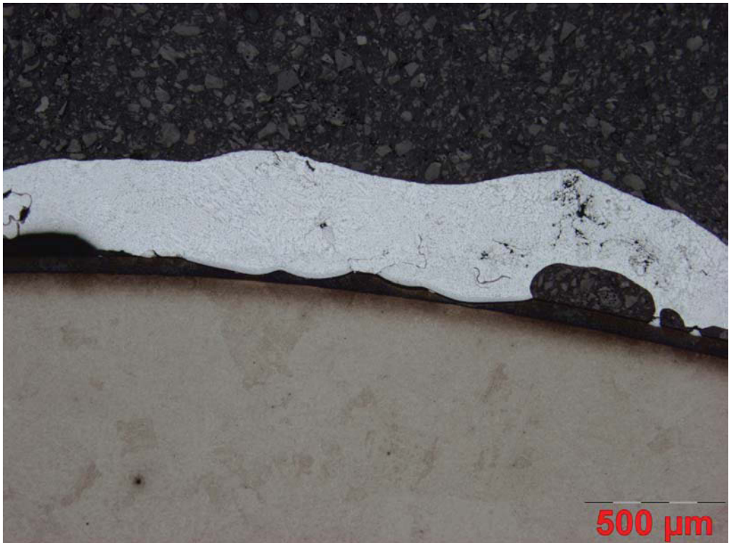
Abbildung Bd19: W300N, Aluminiumlegierung Magsimal-59, Reaktionszeit: 600 sec
