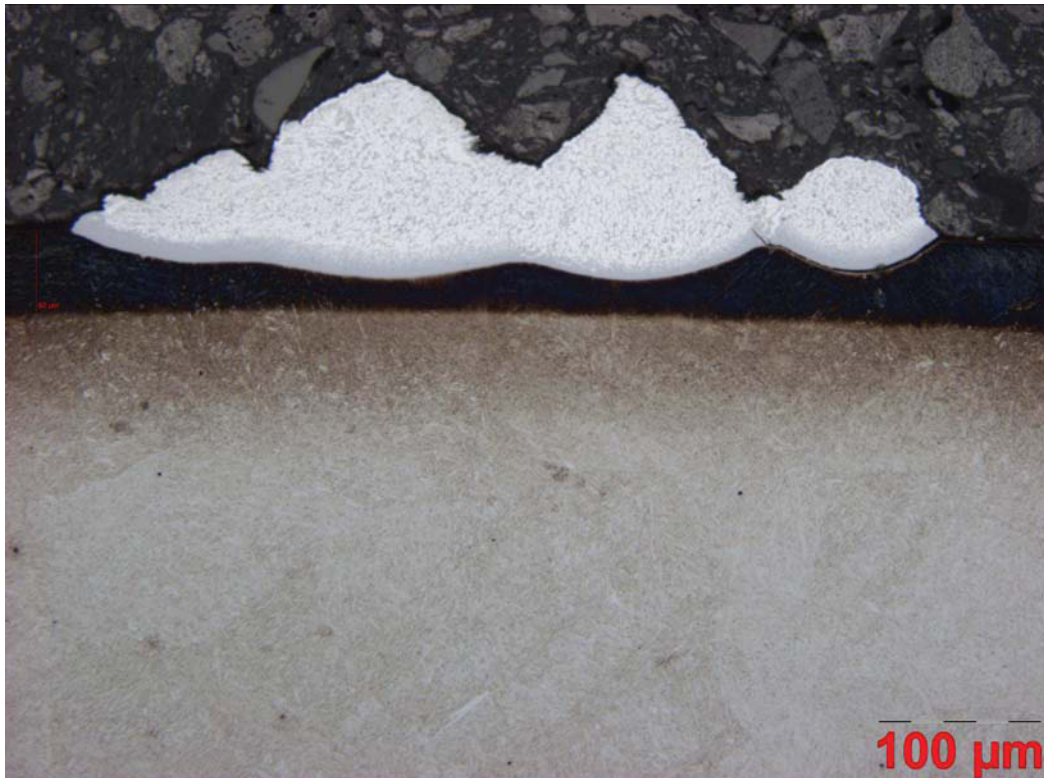
Abbildung 8.7: W300, Aluminiumleg. Magsimal-59, Reaktionszeit: 600sec, Schädigung: leicht
