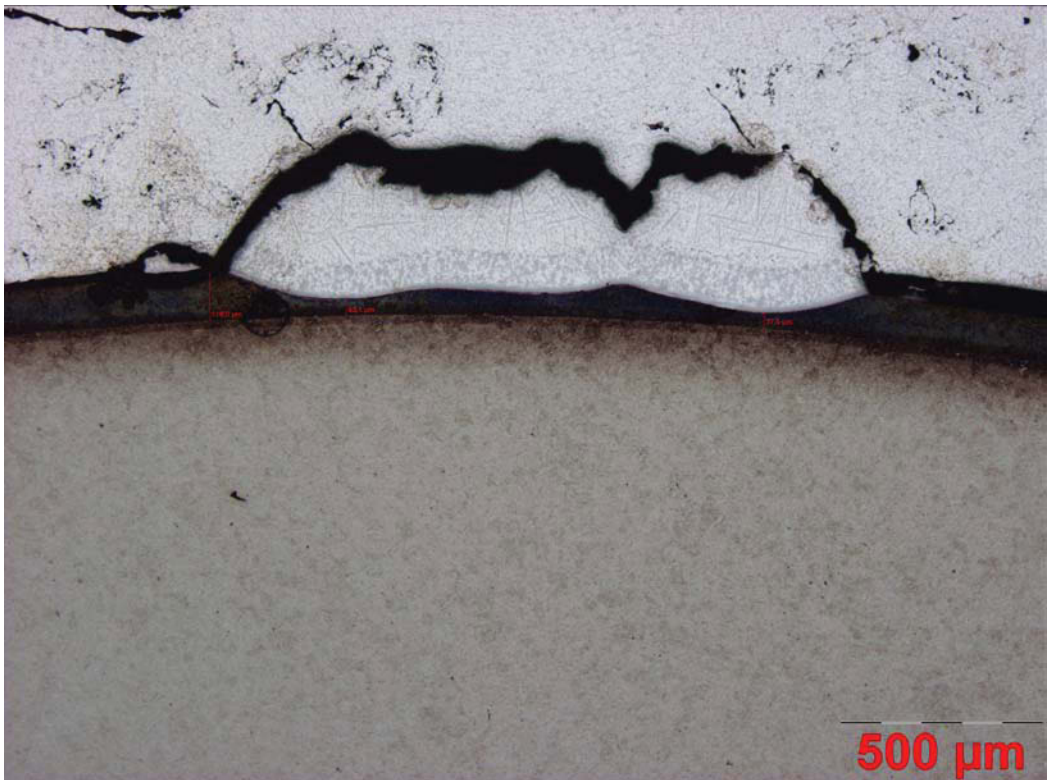
Abbildung Bd9: W315N, Aluminiumlegierung 226, Reaktionszeit: 3000 sec
