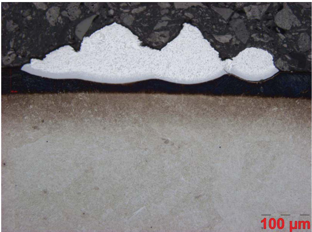
Abbildung Bd18: W300N, Aluminiumlegierung Magsimal-59, Reaktionszeit: 300sec
