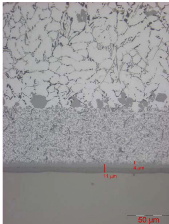
Abbildung Bb8: W300, Aluminiumlegierung 226, t=2400 sec, T=750^{\circ}\text{C}
