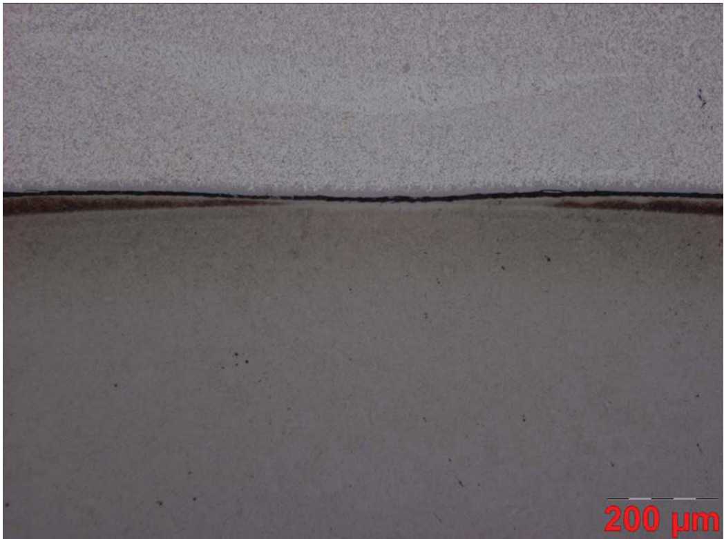
Abbildung Bd33: W315N, Aluminiumlegierung Magsimal-59, Reaktionszeit: 3000 sec
