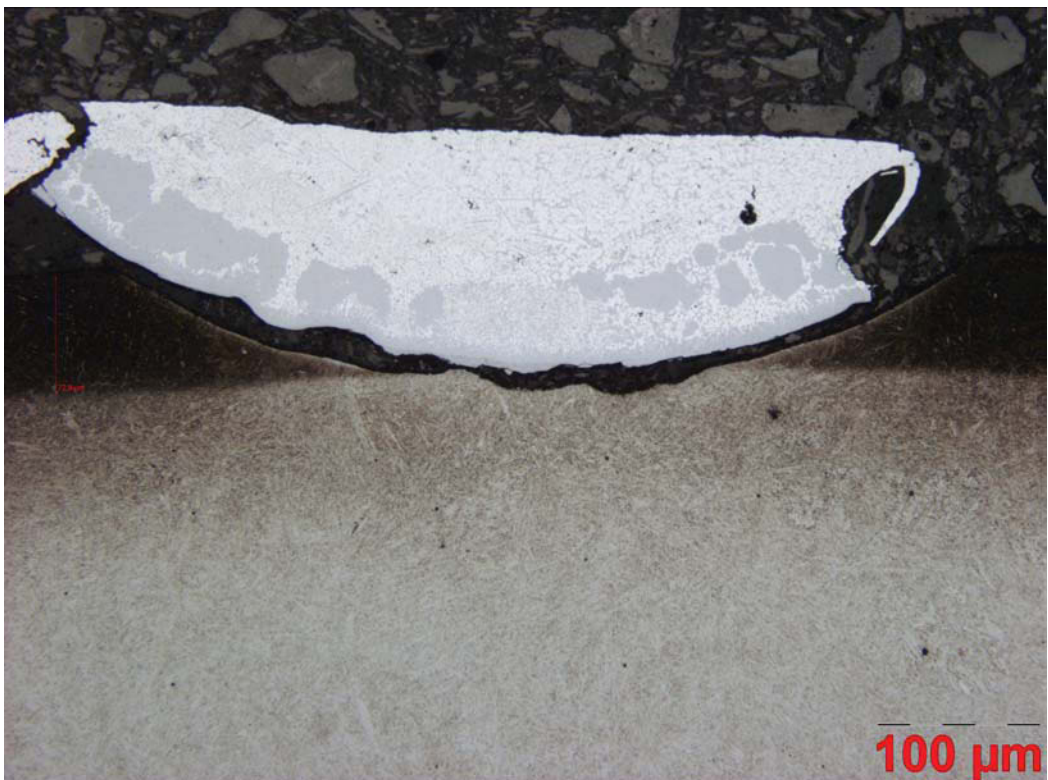
Abbildung Bd3: W300N, Aluminiumlegierung 226, Reaktionszeit: 1200 sec
