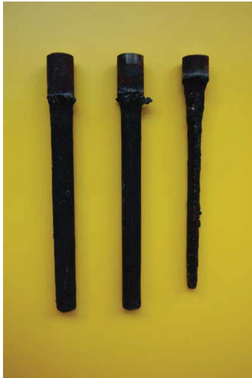
Abbildung Aa2: Versuch 2, W360N (links) W360 (Mitte) W315N (rechts), Aluminiumlegierung 226, T=750°C, Versuchsdauer 10 h
