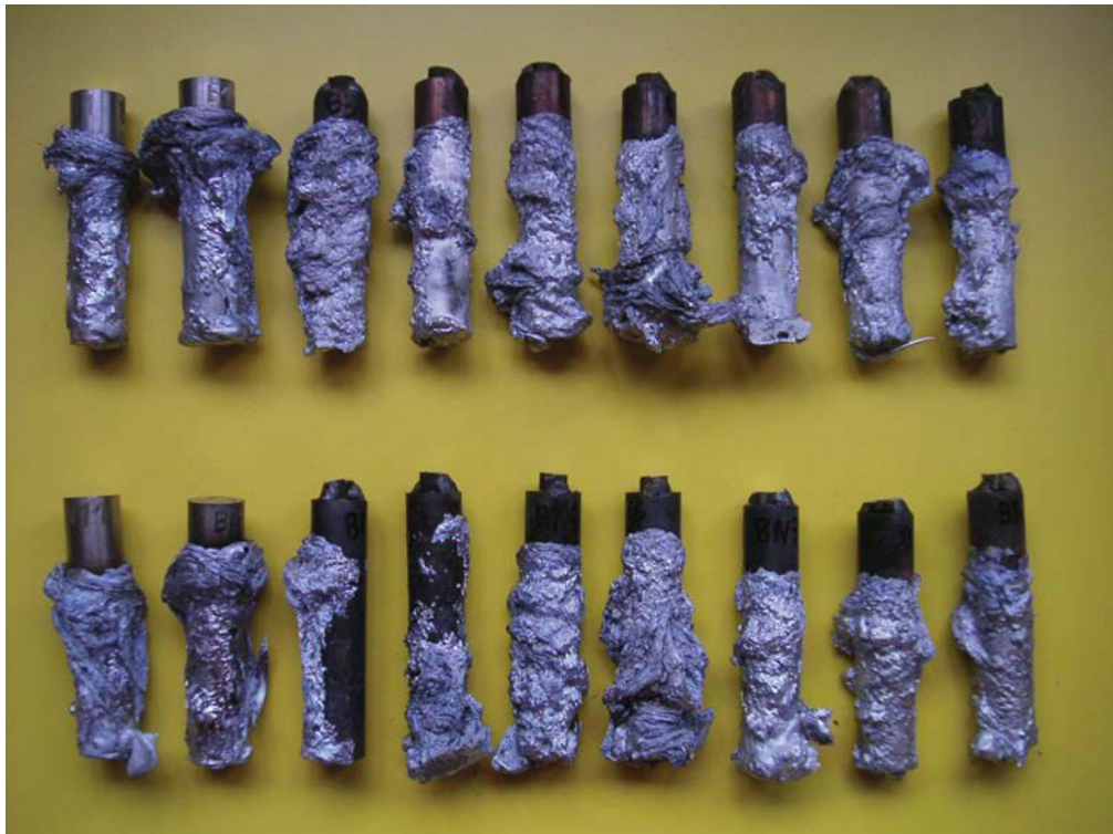
Abbildung Ba 6: W315 (oben) und W315N (unten) – Aluminiumlegierung Magsimal-59 (Reaktionszeiten von links nach rechts: 20, 40, 60, 300, 600, 1200, 1800, 2400 und 3000 sec)
