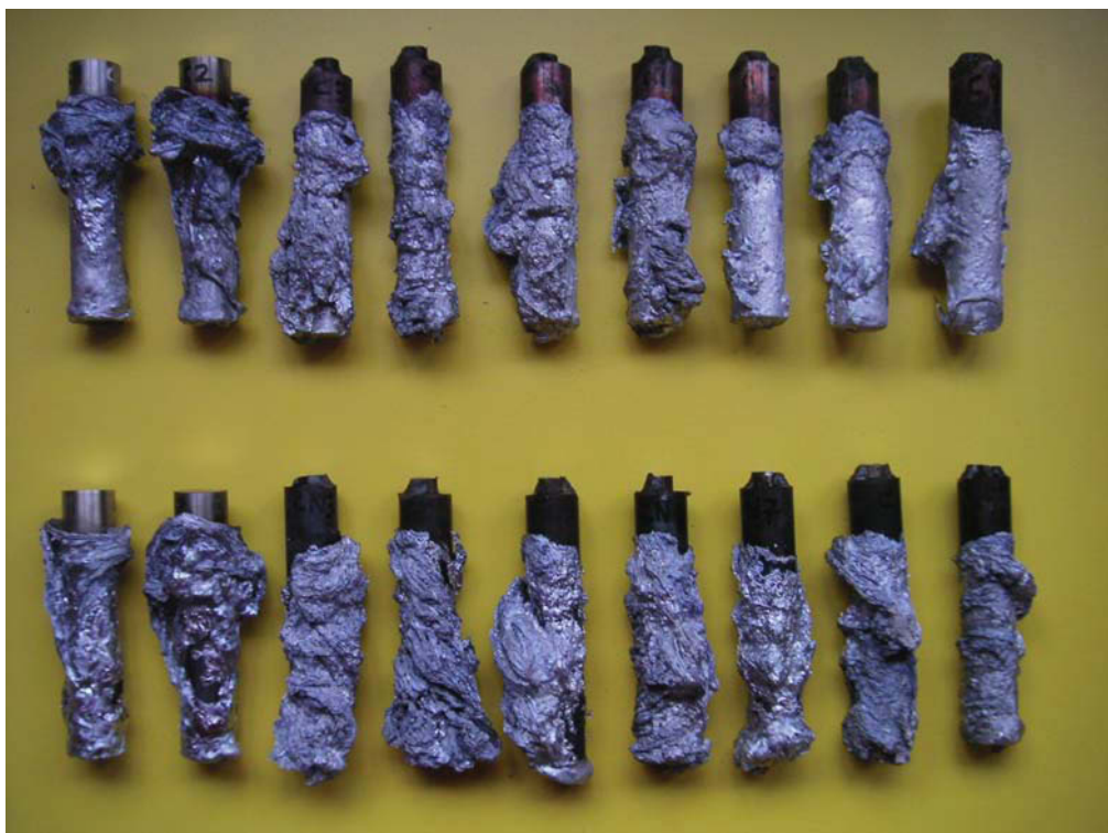
Abbildung Ba 7: W360 (oben) und W360N (unten) – Aluminiumlegierung Magsimal-59 (Reaktionszeiten von links nach rechts: 20, 40, 60, 300, 600, 1200, 1800, 2400 und 3000 sec)
