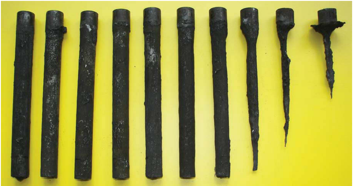
Abbildung Aa6: Zusatzversuch 1, W315, Aluminiumlegierung 226, T=750^{\circ}\text{C} , Versuchsdauer von links nach rechts: 1, 2, 3, 4, 5, 6, 8, 21.5, 26, 32 Stunden
