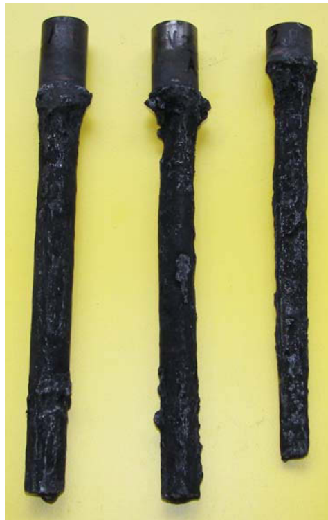
Abbildung Aa1: Versuch 1, W300N (links) W300 (Mitte) W315 (rechts), Aluminiumlegierung 226, T=750°C, Versuchsdauer 10 h
