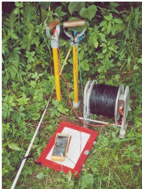
Abbildung 13: SP-Elektroden, Millivoltmeter und Kabel, Messvorrichtung
