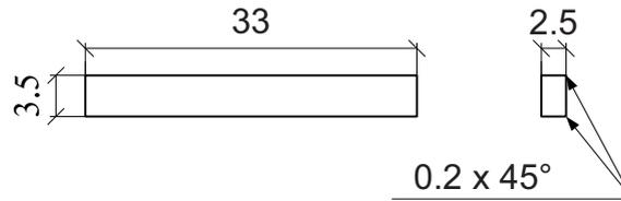
Abb.14: Abmessungen Biegeproben Varistor Typ I.
