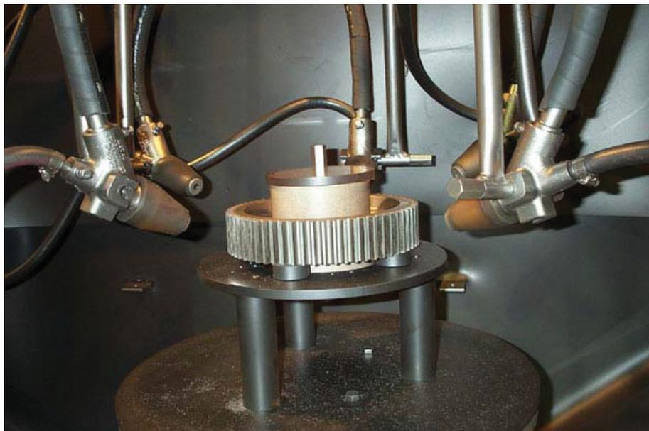
Abbildung 12: Mehrdüsiges Strahlen eines Bauteils in einer geschlossenen Kammer nach [MIC07].
