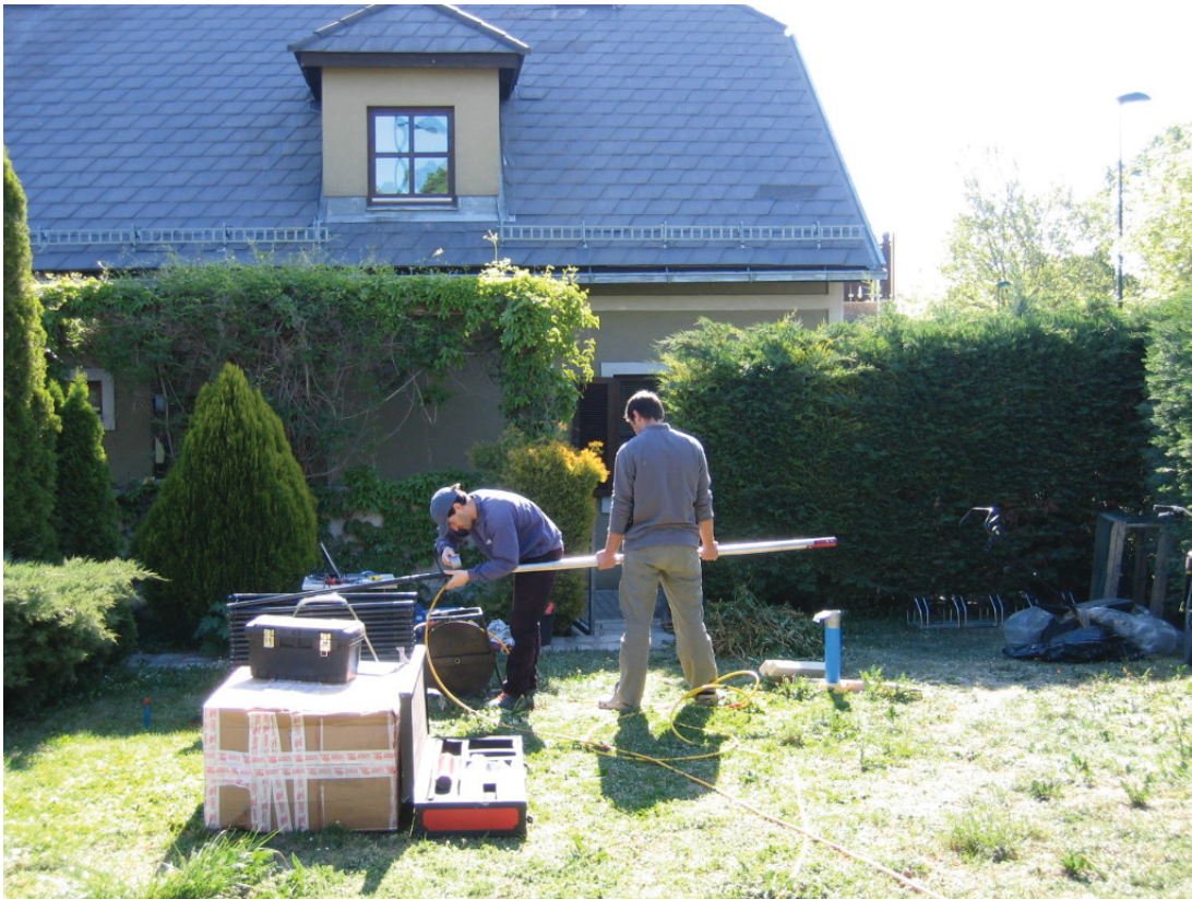
Abb. 50: Laserscanner samt Gestänge
