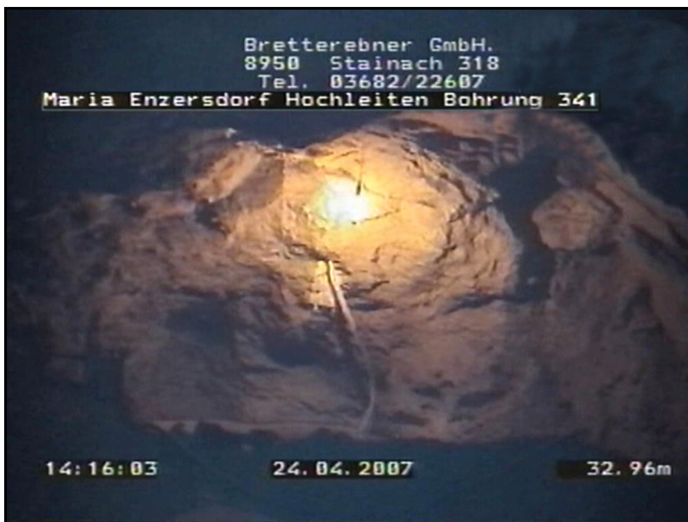
Abb. 30: BL 341; Zusatzlicht wurde in einem benachbarten Bohrloch abgeteuft. Man kann einen Verfüllschlauch aus der Bohrkampagne 2005 erkennen.
