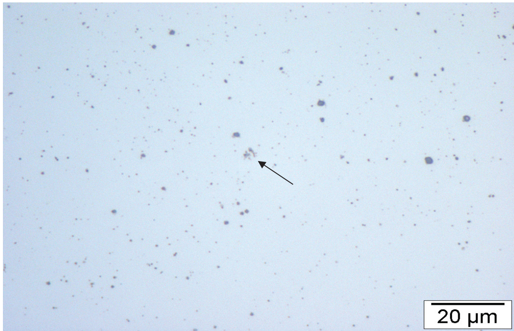
Abb. 4.15: Lichtmikroskopische Aufnahme der Probe IT11_10h mit elektrolytisch angeätzter Sigma – Phase (rötlich) sowie Poren bzw. groben Y_2O_3 – Partikeln mit 1 – 2 \mu m typischer Größe (schwarz)
