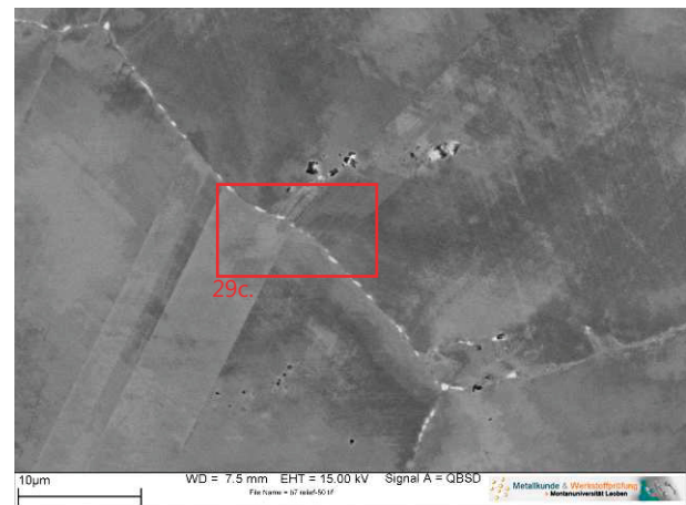
d. LG+980°C/2h (B7), 2000-fach: (Mo, Cr) – reiches Sekundärkarbid an KG (hell), (Ti,Nb)-Primärkarbid (dunkel)
