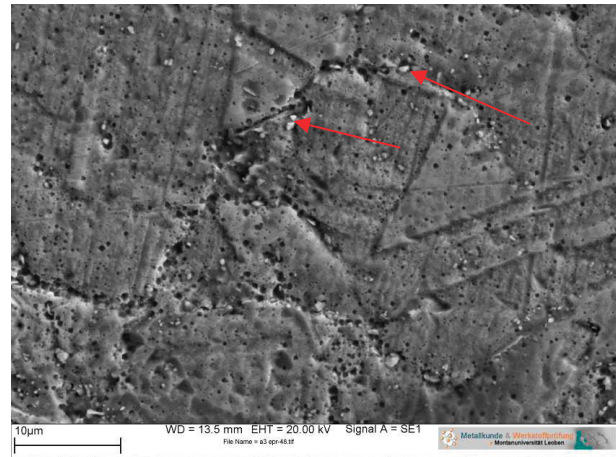
d. SG + 740°C/10h (A3) 2000-fach: Starker globularer Angriff an KG und starker gleichförmiger Abtrag der Körner, M_6C -Karbide (Pfeile rot)
