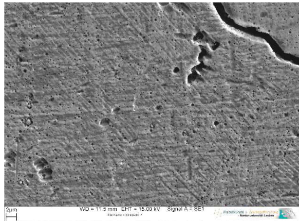
d. LG + 740°C/2h (B3) 2000-fach: Tiefer, kraterförmiger Angriff der Korngrenzen
