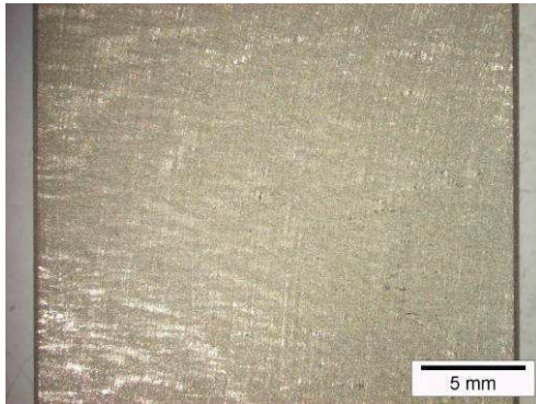
Abb. 44: SG + 740°C/20h (A4) Seite A, gleichmäßiger, leichter Angriff der Oberfläche
