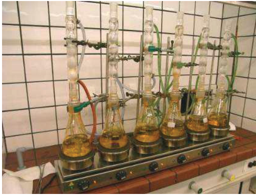
Abb. 34: Übersicht über den Versuchsaufbau; Kolben mit Kühlsäulen und
