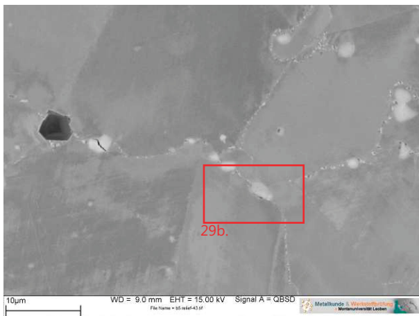
c. LG+800°C/2h (B5), 2000-fach: (Ti,Nb)C-Primärkarbid (dunkel, groß), NbC-Karbid (hell groß), M_6C -Sekundärkarbid (hell klein)
