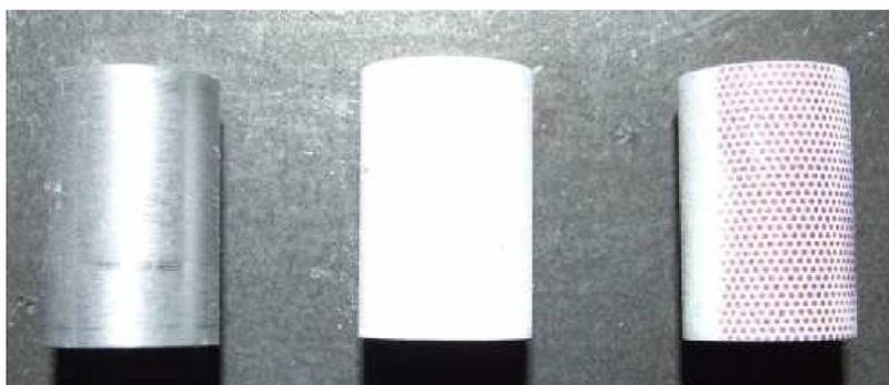
Abbildung 2.14: Probe unpräpariert (links), mit Grundierung (Mitte), mit Muster (rechts)
