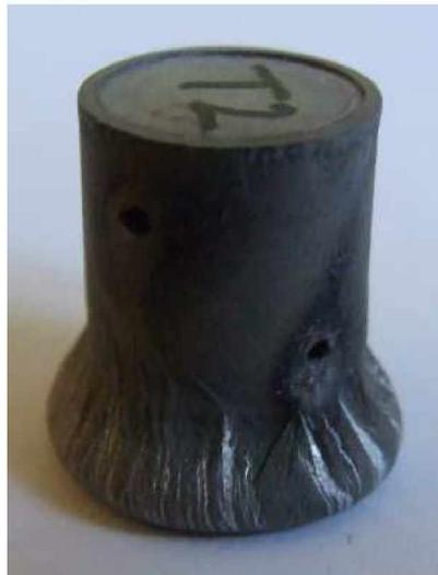
**Abbildung 2.9:** Bei starker Übersteuerung des Induktors kann die Probe überhitzen
