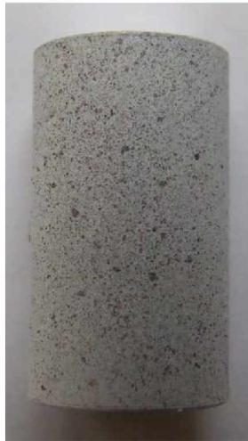
**Abbildung 2.15:** Grundierung mit Titanoxid und Muster aus Eisen(III)oxid
