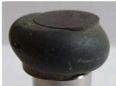
**Abbildung 3.1:** Stauchversuch der Probe 1.2 auf der Servotest
