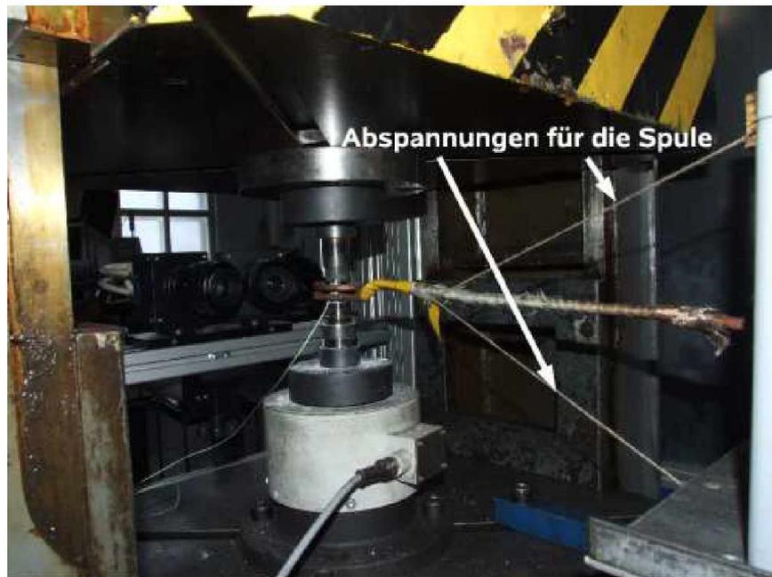
**Abbildung 2.11:** Mit Hilfe von Schnüren wird verhindert, dass die Spule ins Bild schwingt
