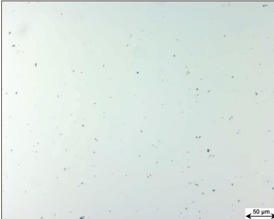
Abb.6.7: Punktförmige Einschlüsse im Fe - Cr - Ni-Material, ungeätzt.
