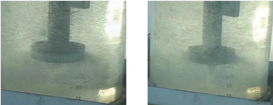
Abbildung 4-43: Vergleich von 350 U/min (linkes Bild) und 500 U/min (rechtes Bild) [52]
