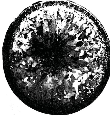
Abbildung 4-41: Makrostruktur eines Kupferblockes mit einem Durchmesser von 180 mm [48]
