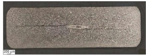
b) Seigerungsstruktur im Querschnitt des C50-PD-TK
