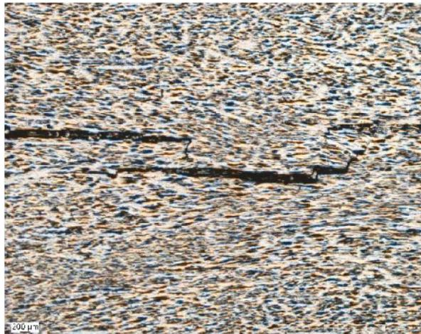
c) Detailaufnahme der Seigerung in der Nähe eines Risses im Querschnitt des C50-PD
