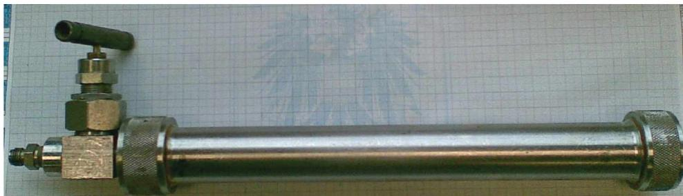
**Abb. 3.17: Autoklave für den SSC-Test**
