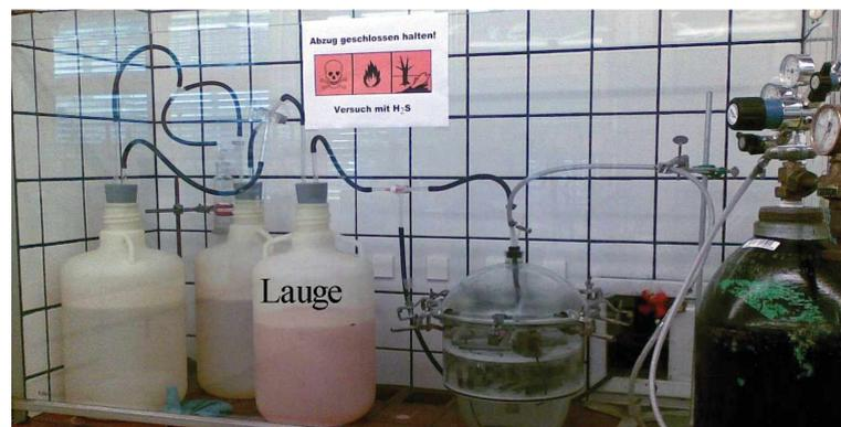
**Abb. 3.23: HIC-Versuchsaufbau**
