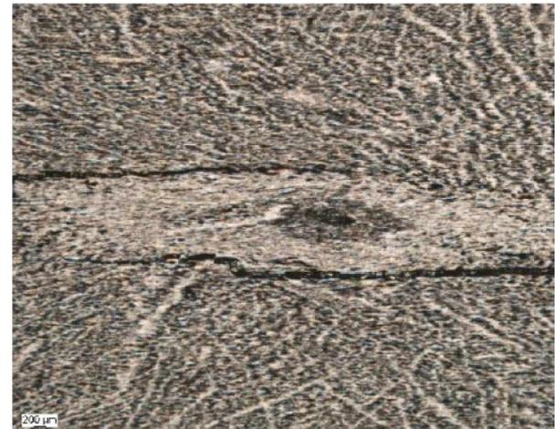
d) Detailaufnahme der Seigerung in der Nähe eines Risses im Querschnitt des C50-PD-TK
