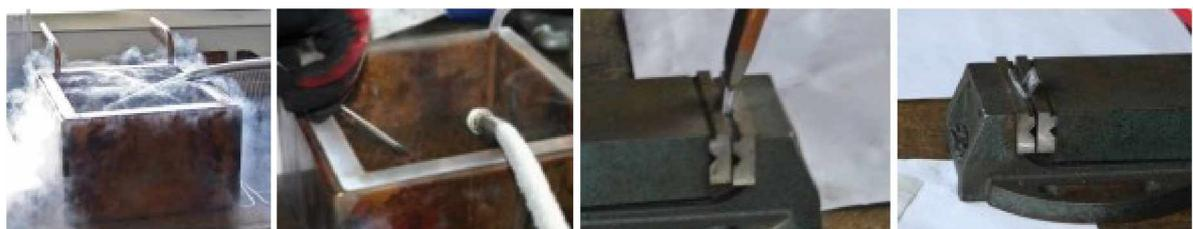
**Abb. 4.26: Rissöffnung bei den HIC-Proben mit Hilfe von flüssigem Stickstoff**
