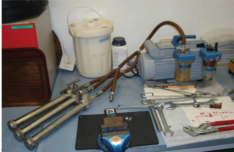
**Abb. 3.18: Evakuierung der Autoklaven mittels Vakuumpumpe**
