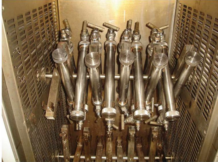
**Abb. 3.20: Drehschrank zum Bewegen des Autoklaven**
